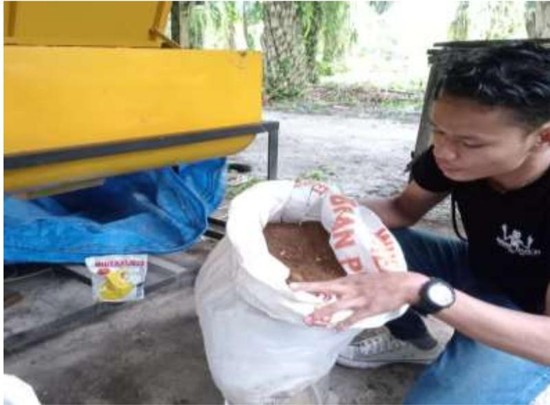
Gambar Hasil penggilingan mesin pakan puyuh dengan kecepatan 400 rpm
