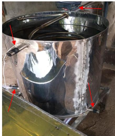
Gambar 3.21 pemasangan 4 titik thermocouple
