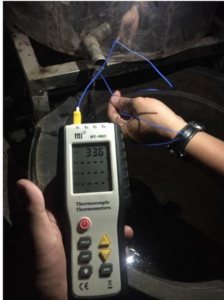
Gambarr 3.22 Pengukuran suhu minyak nilam menggunakan thermokopel
