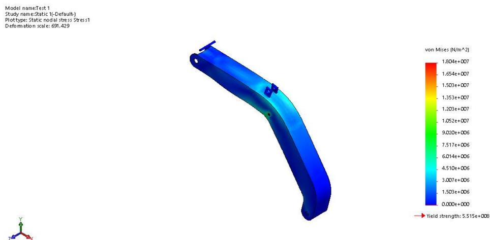
Gambar 4.4 Hasil Tegangan *Boom*
