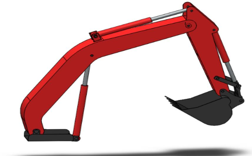
Gambar 4.1 Hasil Rancangan Model Lengan *Excavator*
