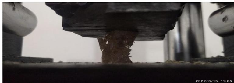
Gambar 4.8 Spesimen 2 Sebelum di Uji Tekan
