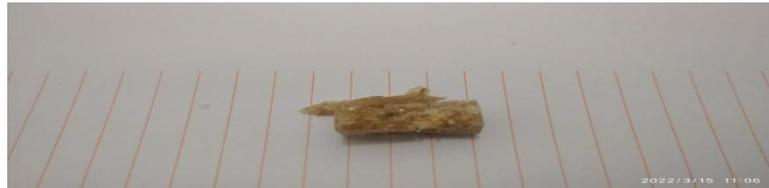
Gambar 4.9 Spesimen 2 Setelah di Uji Tekan
