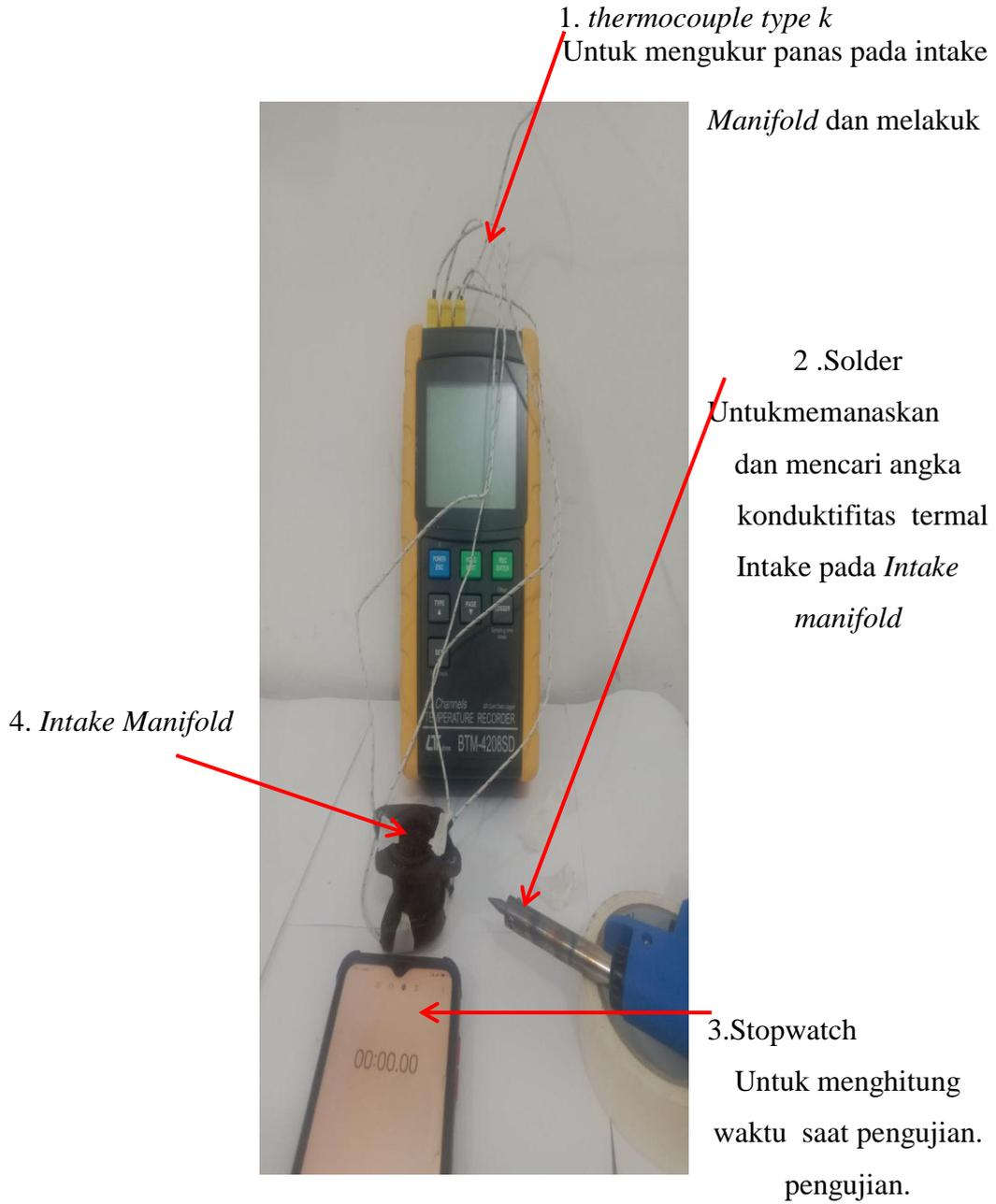
Gambar 3.7 *Seet Up* Alat Uji Konduktifitas Thermal
