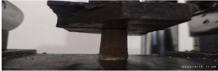
Gambar 4.6 Spesimen 1 Sebelum di Uji Tekan
