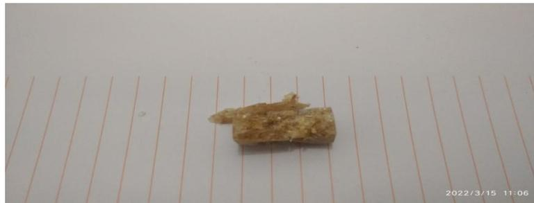
Gambar 4.7 Spesimen 1 Setelah di Uji Tekan
