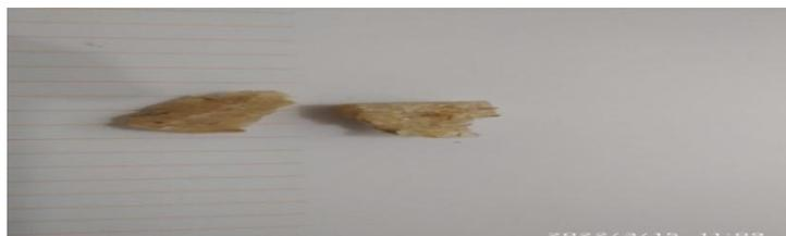
Gambar 4.13 Spesimen 4 Setelah di Uji Tekan
