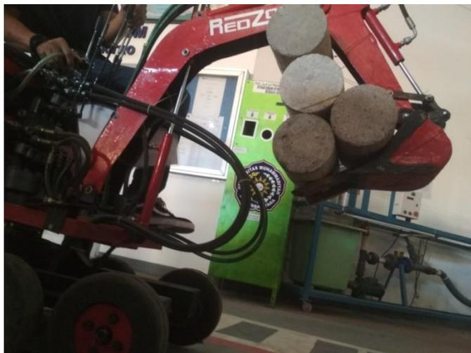
Gambar 4.32 Lengan excavator mengangkat beban 40 kg
