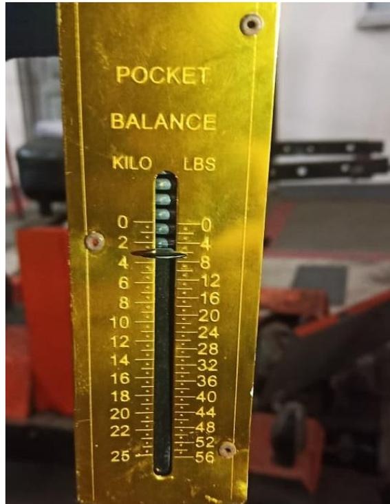
Gambar 4.23 Pembebanan mesin 3 kg pada alat ukur beban brake dynamometer
