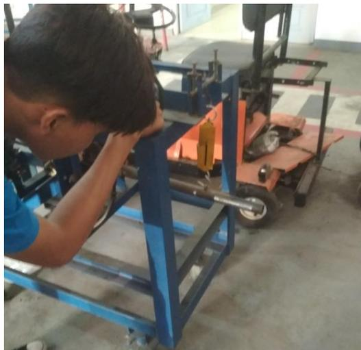
Gambar 4.4 Proses penyetelan beban brake dynamometer
