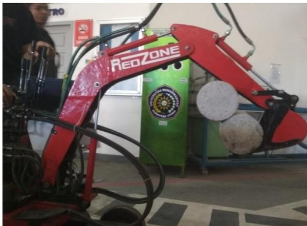
Gambar 4.30 Lengan excavator mengangkat beban 20 kg
