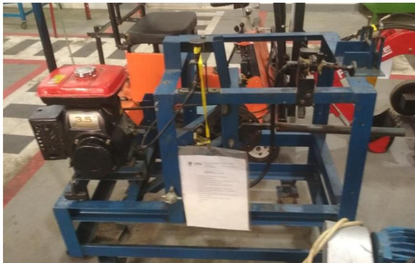
Gambar 3.6 Brake dynamometer
