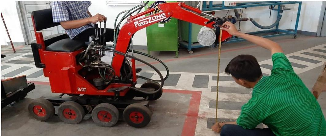
Gambar 4.15 Pengukuran mampu tinggi angkat beban lengan excavator.
