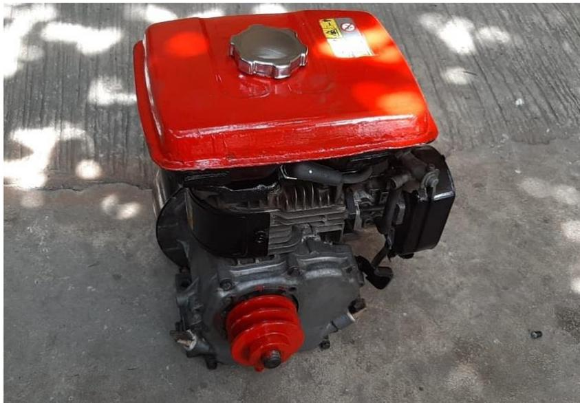
Gambar 3.1 Mesin penggerak mesin Robin EY15DJ
