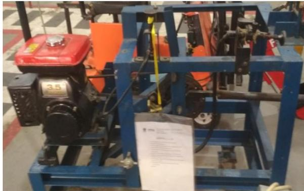
Gambar 4.1 Mesin Robin terpasang pada alat uji brake dynamometer
