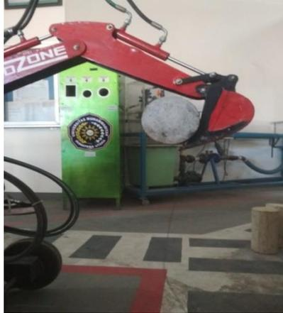
Gambar 4.29 Lengan excavator mengangkat beban 10 kg
