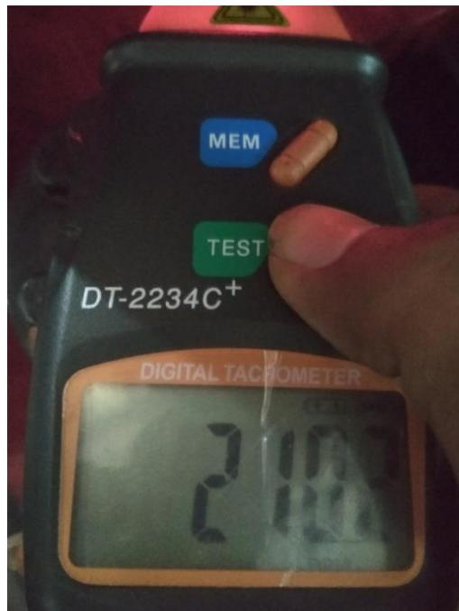
Gambar 4.21 Rpm mesin pada pembebanan 2 kg
