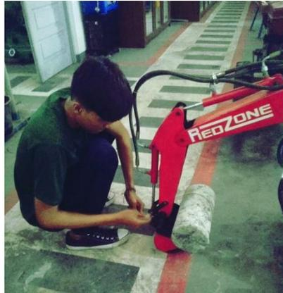
Gambar 4.11 Pengikatan beban pada bucket excavator.
