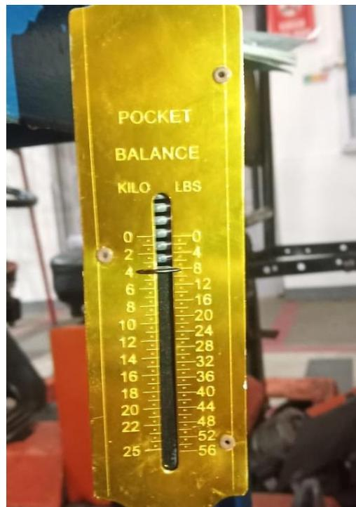
Gambar 4.26 Pembebanan mesin 4 kg pada alat ukur beban brake dynamometer
