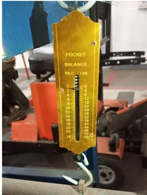
Gambar 4.17 Pembebanan mesin 1 kg pada alat ukur beban brake dynamometer
