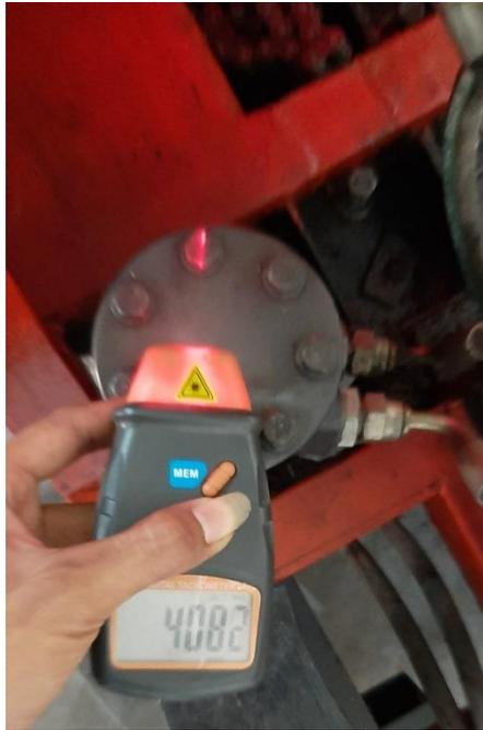
Gambar 4.3 Memastikan putaran awal mesin 4000 Rpm
