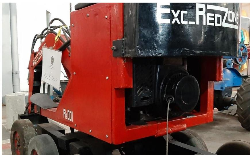
Gambar 4.8 Mesin Robin terpasang pada model excavator
