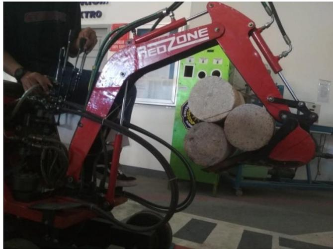
Gambar 4.31 Lengan excavator mengangkat beban 30 kg
