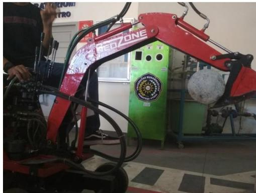
Gambar 4.12 Pengujian pengangkatan beban oleh lengan excavator.
