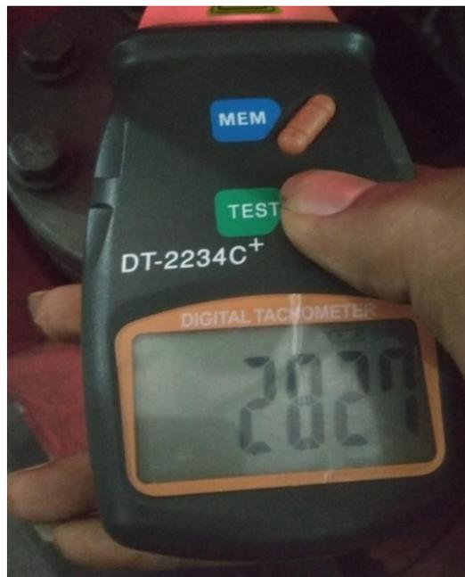
Gambar 4.18 Rpm mesin pada pembebanan 1 kg
