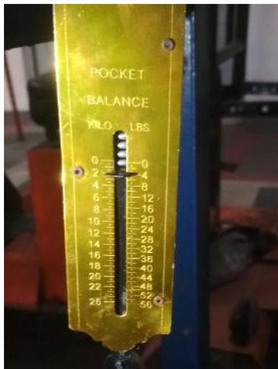
Gambar 4.20 Pembebanan mesin 2 kg pada alat ukur beban brake dynamometer
