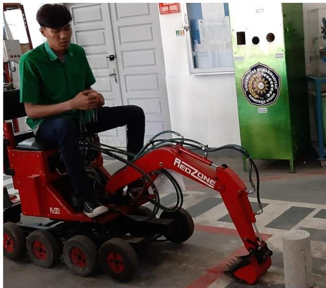
Gambar 4.10 Pengecekan system gerak lengan excavator sebelum pengujian.
