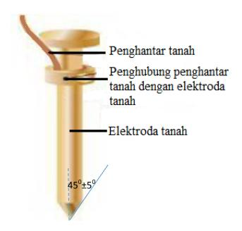
Gambar 2.7 Elektroda Batang
