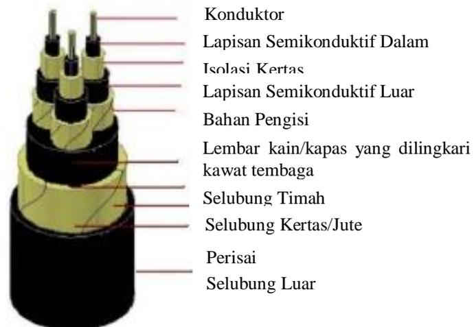
Gambar 2.13 Kabel Tegangan Menengah Isolasi Kertas Berinti Tiga
