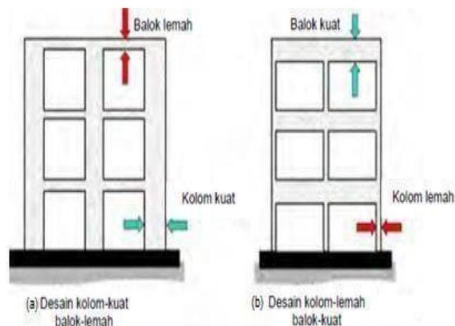
Gambar 2.4: Ilustrasi desain SCWB struktur beton bertulang.
