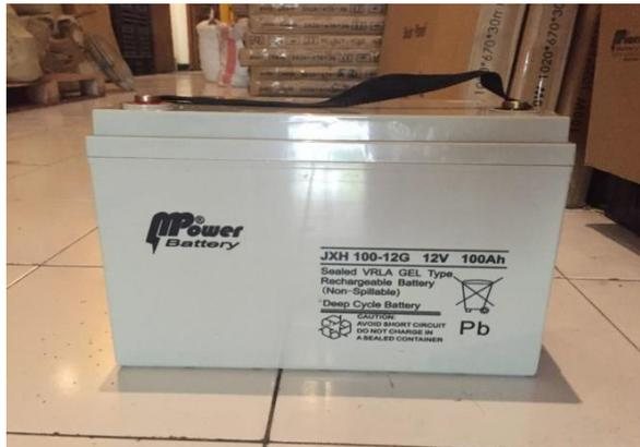
Gambar 4.4. Baterai Tipe VRLA
