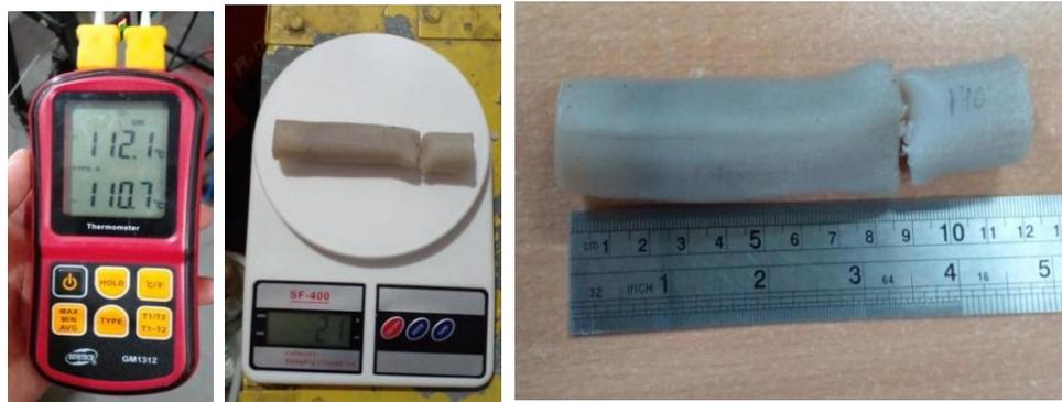
Gambar 4. 2 Hasil ekstrusi dengan temperatur 110°C
