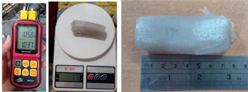
Gambar 4. 1 Hasil ekstrusi dengan temperatur 100°C
