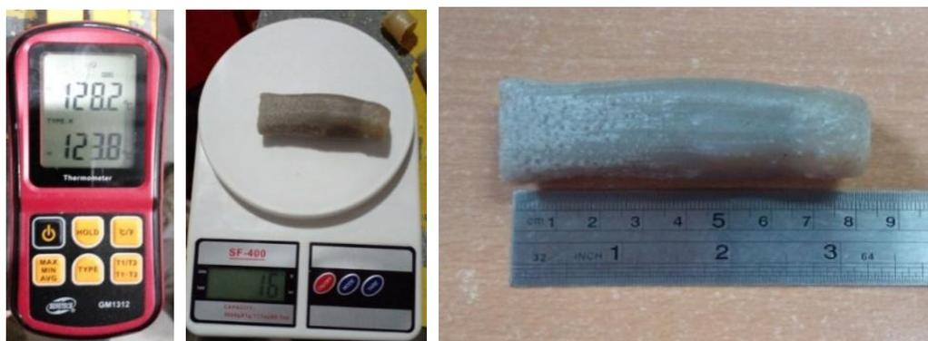
Gambar 4. 3 Hasil ekstrusi dengan temperatur 120 °C
