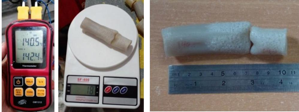
Gambar 4. 5 Hasil ekstrusi dengan temperatur 140°C
