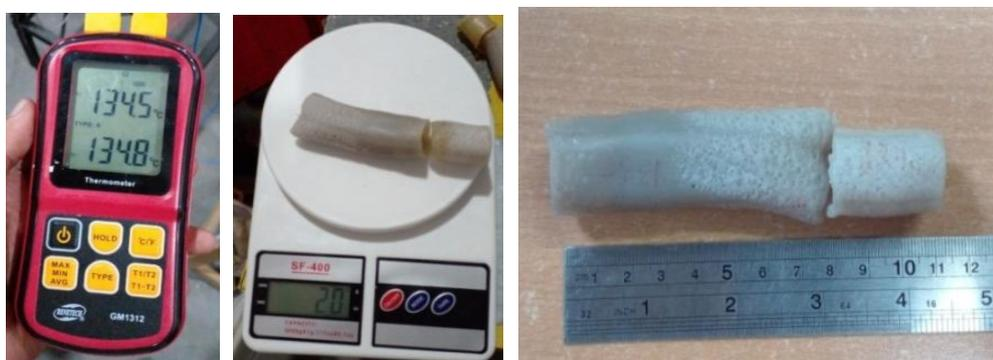
Gambar 4. 4 Hasil ekstrusi dengan temperatur 130 °C
