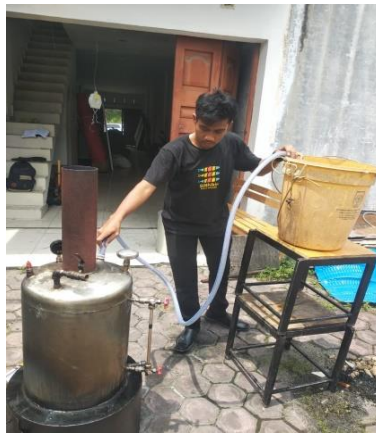
Gambar 3.13 Memasukan air kedalam drum boiler
