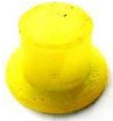
Gambar 2.9. Spesimen pada temperatur injeksi 165 °C. (Mawardi, 2015)
