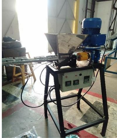
Gambar 3.3. Alat uji mesin ekstruksi plastik
