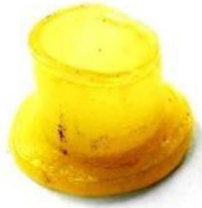
Gambar 2.8. Spesimen pada temperatur injeksi 160 °C. (Mawardi, 2015)
