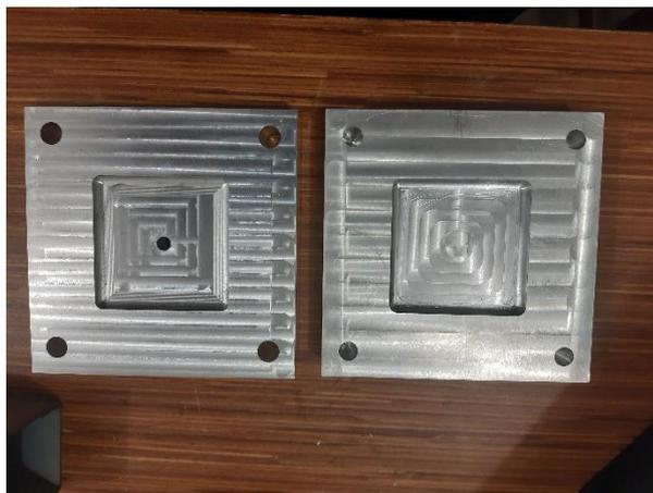
Gambar 4.3 *Mold (Cetakan)*
