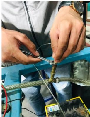
Gambar 4.17. Pemasangan sensor menuju radiator
