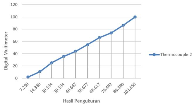
Gambar 4.32 Grafik Perbandingan Suhu Pada Digital Multimeter Dengan Hasil Pengukuran Suhu Pada Sensor Themocouple 2
