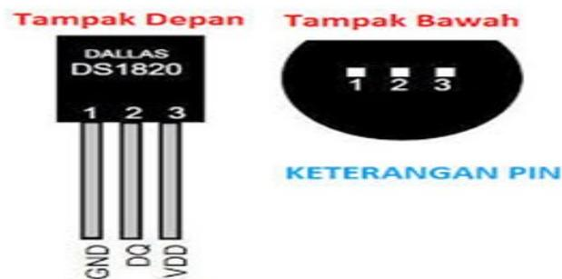
Gambar 2.7 Bentuk Fisik Sensor Suhu DS18B20
