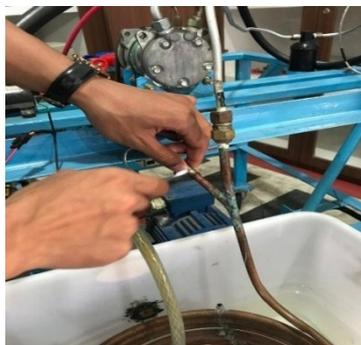
Gambar 4.15. Memasang sensor pada kondensor
