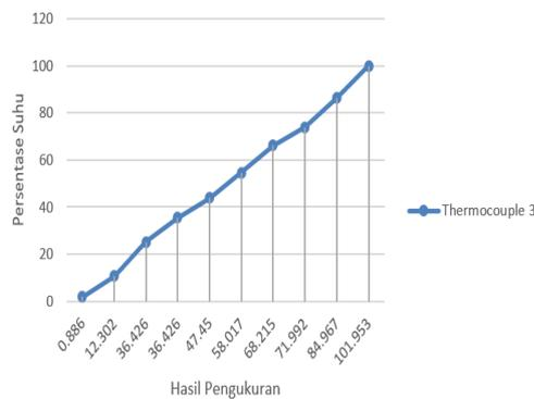
Gambar 4.34 Grafik Perbandingan Suhu Pada Digital Multimeter Dengan Hasil Pengukuran Suhu Pada Sensor Themocouple 3
