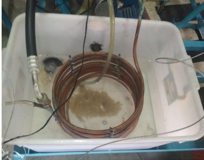
Gambar 3.31 Menguji Melihat Ada Kebocoran Tidak
