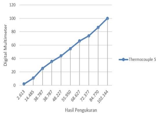
Gambar 4.38 Grafik Perbandingan Suhu Pada Digital Multimeter Dengan Hasil Pengukuran Suhu Pada Sensor Themocouple 5
