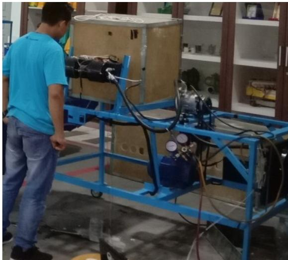
Gambar 3.34 Pengoprasian AC Mobil
