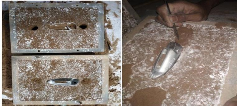
Gambar 4.11. Mengangkat Cetakan Bagian Atas dan Membuat Saluran Masuk (*ingate*)
