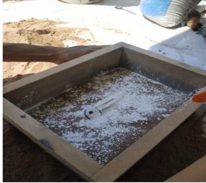
Gambar 4.8. Memasang Cetakan Bagian Atas dan Menaburkan Serbuk Pemisah
