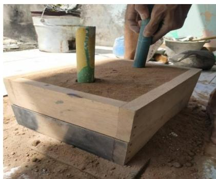
Gambar 4.10. Membuat Saluran Masuk dan Saluran Buang
