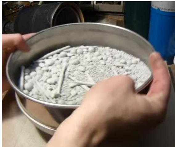
Gambar 4.1. Menyaring Bahan Pasir, Bentonite dan Abu Vulkanik
