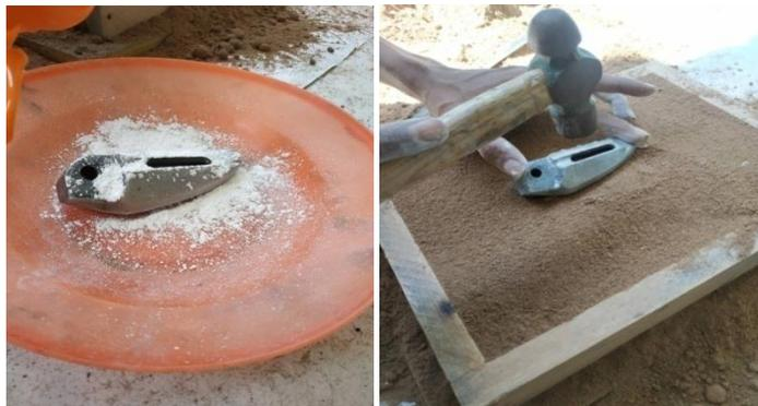
Gambar 4.6. Menaburkan Serbuk Pemisah dan Meletakkan Pola di Tengah Cetakan
