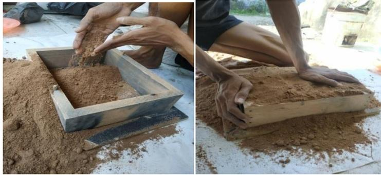
Gambar 4.5. Mengisi Cetakan dan Memadatkan Pasir
