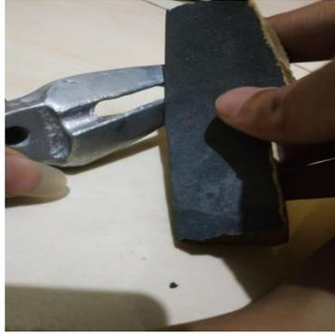
Gambar 4.18. Menghaluskan permukaan produk dengan menggunakan kertas pasir
