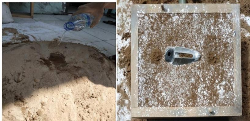
Gambar 3.15. Proses Menyetak
