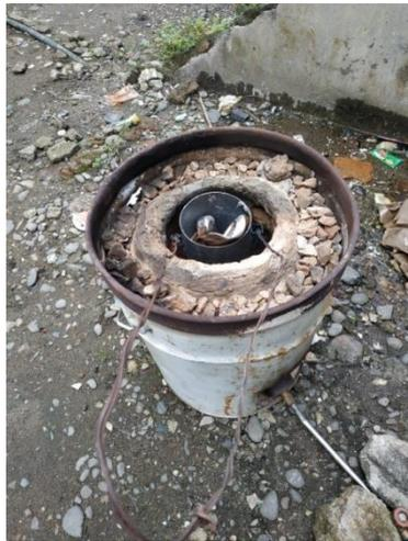
Gambar 3.18 Melebur Alumunium
