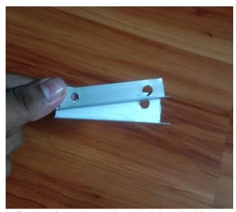
Gambar 3.11 Alumunium Dudukan Turbin
