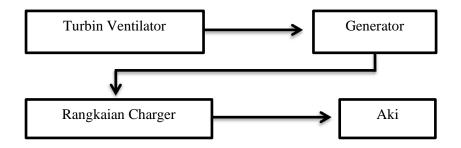
Gambar 2.3 Diagram Blok Alat
