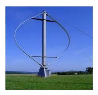
Gambar 2.2 Turbin Angin Sumbu Vertikal
