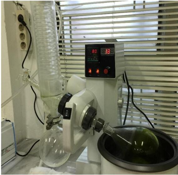
Evaporator (proses pengekstrakan daun sirsak)
