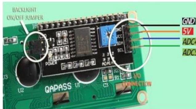
Gambar 2.13. Konfigurasi PIN LCD
