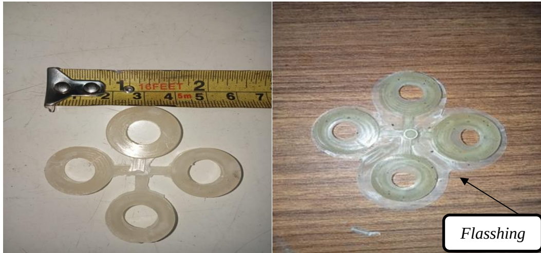
Gambar 4.28 Hasil Pendinginan 13 menit pada suhu pemanas 180°C
