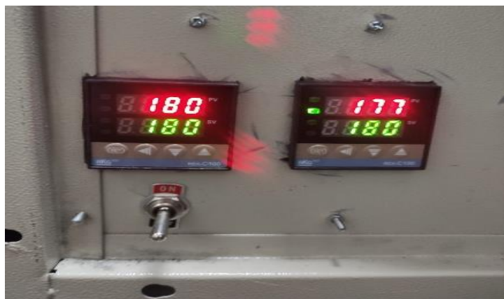
Gambar 4.14 Penyetelan suhu pada PID
