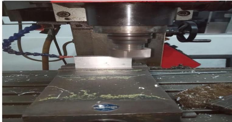
Gambar 4.5 Melakukan pemakanan dengan ukuran yang telah di tentukan
