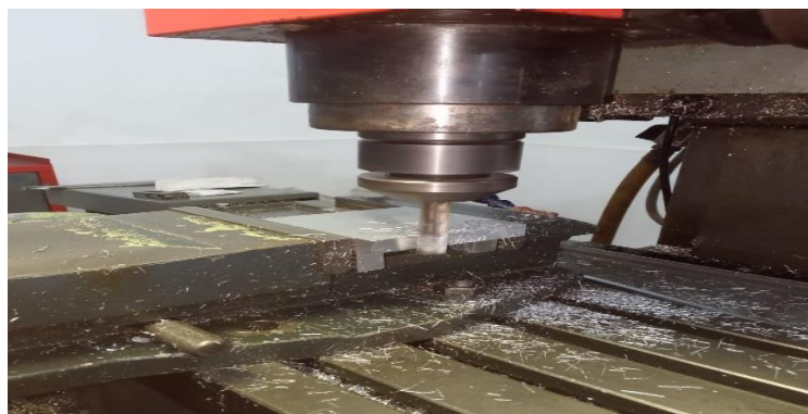
Gambar 4.7 Melakukan proses facing menggunakan mesin CNC
