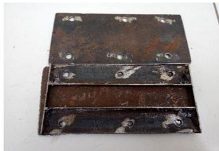
Gambar 3.5. Cetakan specimen uji lentur (Dokumen pribadi)
