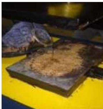
Gambar 3.29. Menuangkan kembali resin ke cetakan (Dokumen pribadi)
