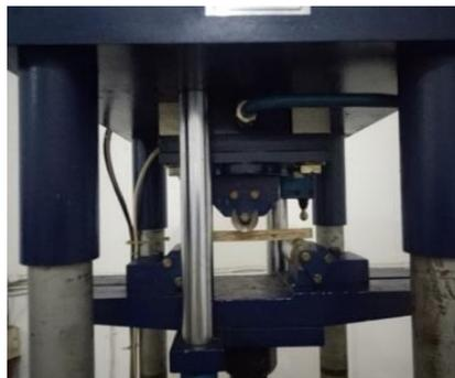
Gambar.3.39. Proses pengujian Lentur (Dokumen pribadi)
