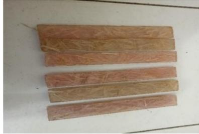
Gambar 3.38. Pengeringan spesimen uji Lentur (Dokumen pribadi)
