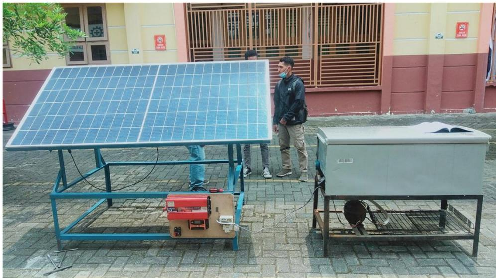
Gambar 4.4 Pengujian *Solar Cell* Terhadap Lemari Pembeku
