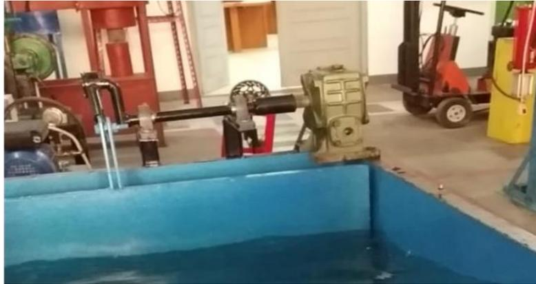
Gambar 4.18 Mesin Pendorong Gelombang Air
