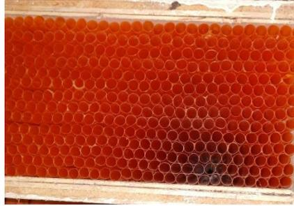
Gambar 3.15 Pelurus Aliran Udara (*Flow Straightener*)
