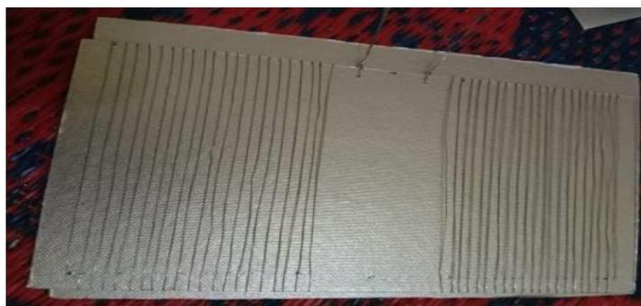
Gambar 3.32 Pemanas Listrik (*electric heater*)
