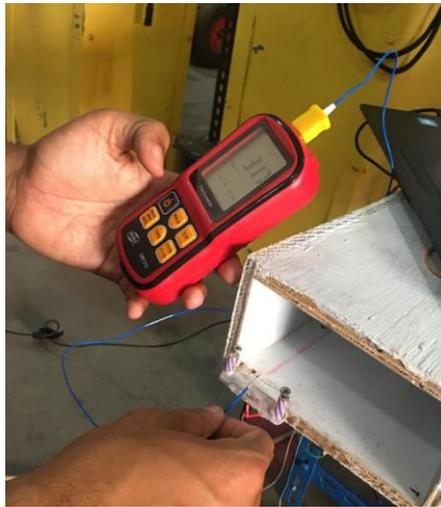
Gambar 4.9 Mengukur temperatur pada kawat
