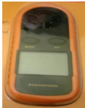
Gambar 3.9 Anemometer
