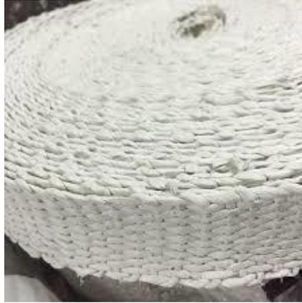
Gambar 3.33 Isolasi Asbes
