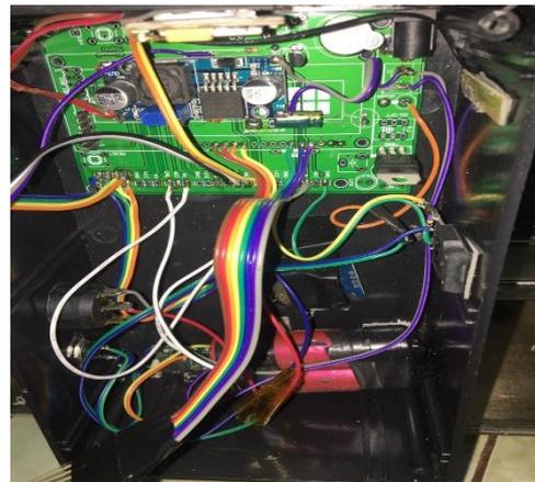
Gambar 4.1 Rangkaian Mikrocontroller, SIM 800L, buzzer, IRF540 dan RTC DS3231
