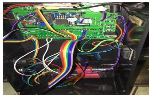
Gambar 4.2 Rangkaian tag PN532 dan LCD 16 x 2
