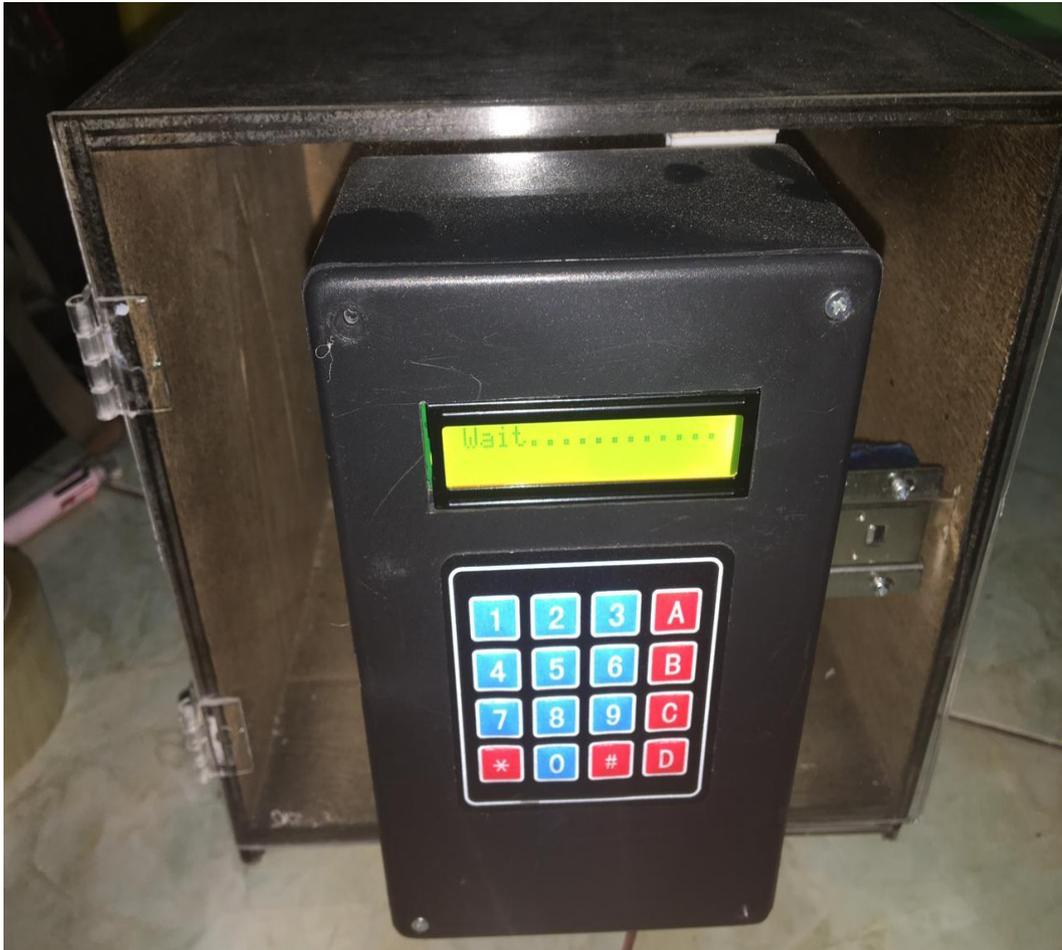
Gambar 4.3 Hasil Rancangan alat Sistem Keamanan Brankas secara keseluruhan
