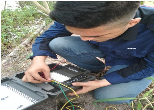
Gambar 4.7 Proses Pengukuran Resistansi Tanah
