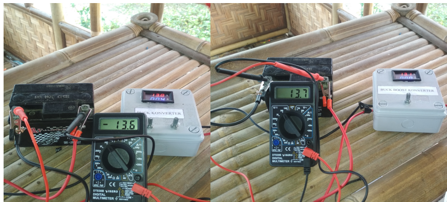
Gambar 5 Proses pengujian pengisian baterai buck dan buck – boost converter
