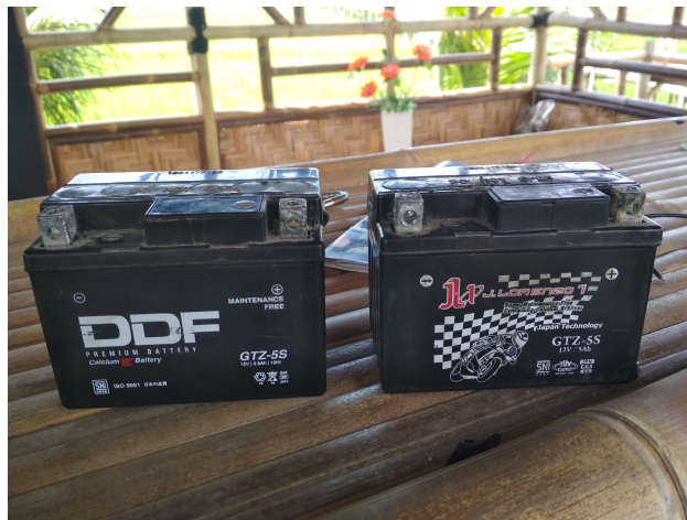
Gambar 6 baterai 12 volt 3.5 Ah
