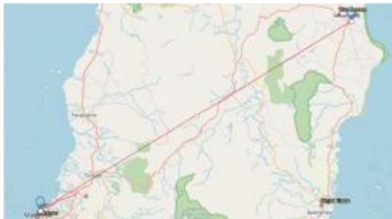
Pada gambar, Kota Makassar ke Kota Watampone tertulis skala 1 : 2.000.000, artinya jarak 1 cm pada gambar mewakili jarak yang sesungguhnya, yaitu 2.000.000 cm. Jadi, skala adalah perbandingan jarak pada gambar/peta dengan jarak yang sesungguhnya. Jika dikembalikan ke bentuk perbandingan menjadi ?
