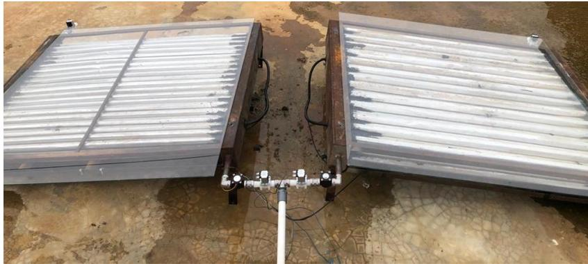
Gambar 4.1 Hasil Pembuatan *Solar Water Heater Double Slope*
