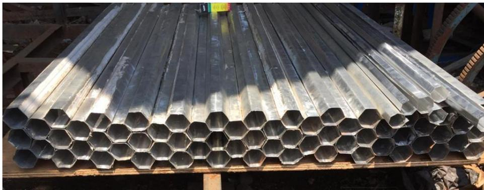
Gambar 4.7 Pembuatan *Honeycomb*
