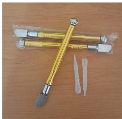
Gambar 3.15 Pemotong kaca (*glass cutter*)
