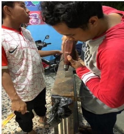
Gambar 4.11 Melubangi Rangka *Honeycomb*
