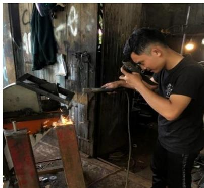
Gambar 3.24 Mengelas Rangka *Solar Water Heater*
