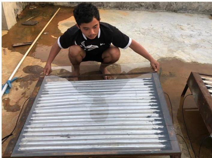
Gambar 4.13 Pemasangan Kaca Penutup
