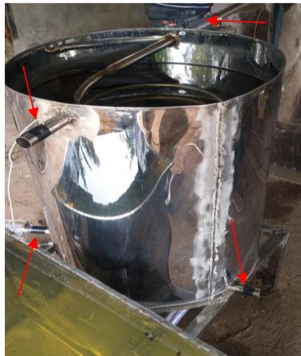
Gambar 3.19 pemasangan 4 titik thermocouple
