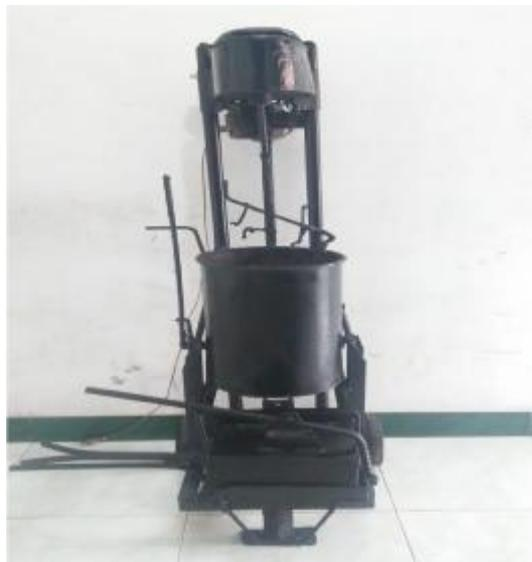
Gambar 3.3 Alat Pembuat Paving blok
