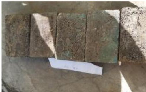
Gambar 4.6 paving block campuran botol plastik 50% dan botol pasir 50%
