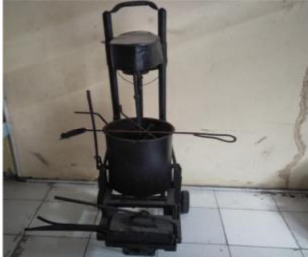
Gambar 4.3 Alat pembuat paving block
