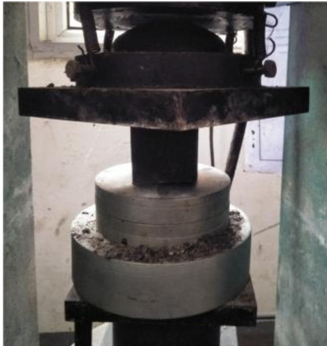
Gambar 4.10 peletakan paving block untuk pengujian
