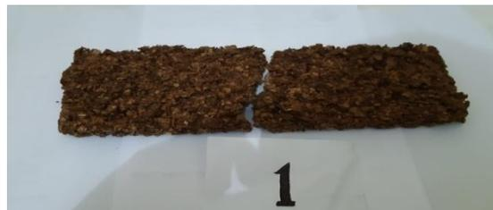
Gambar 4.3 Spesimen 1 *matriks* pertama Hasil Pengujian *Three Point Bending*
