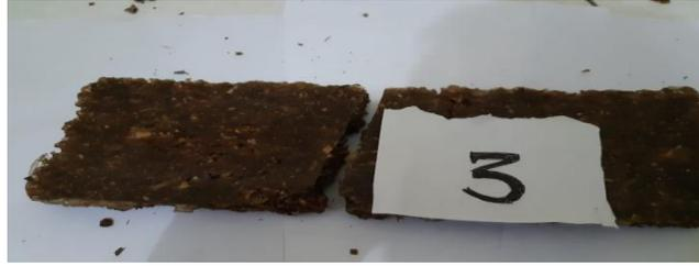
Gambar 4.39 spesimen 3 *matriks* ketiga hasil pengujian *Three Point Bending*
