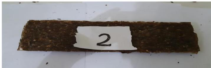
Gambar 4.35 spesimen uji 2 *matriks* ketiga sebelum pengujian
