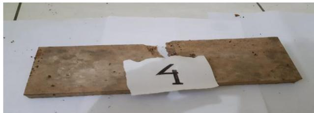
Gambar 4.72 spesimen 4 *matriks* kelima hasil pengujian *Three Point Bending*
