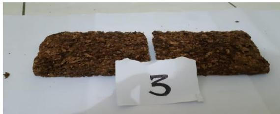
Gambar 4.9 spesimen 3 *matriks* pertama hasil pengujian *Three Point Bending*
