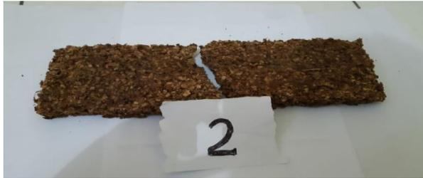
Gambar 4.6 Spesimen 2 *matriks* pertama hasil pengujian *Three Point Bending*
