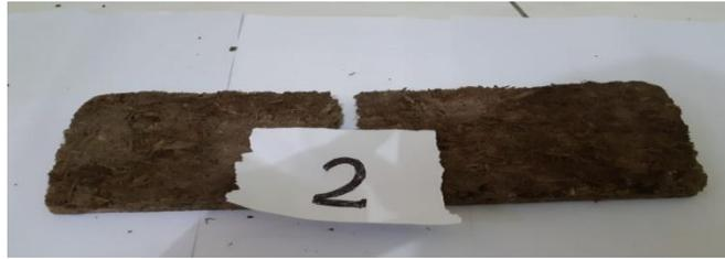
Gambar 4.21 spesimen 2 *matriks* kedua hasil pengujian *Three Point Bending*
