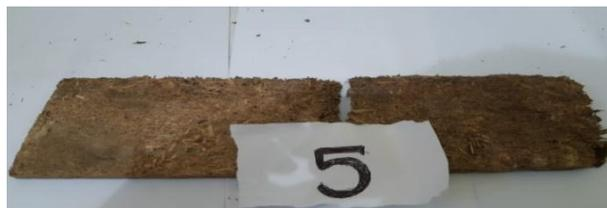
Gambar 4.30 spesimen 5 *matriks* kedua hasil pengujian Three Point Bending
