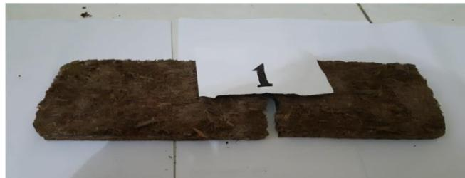
Gambar 4.18 spesimen 1 *matriks* kedua hasil pengujian *Three Point Bending*
