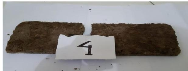
Gambar 4.27 spesimen 4 *matriks* kedua hasil pengujian *Three Point Bending*
