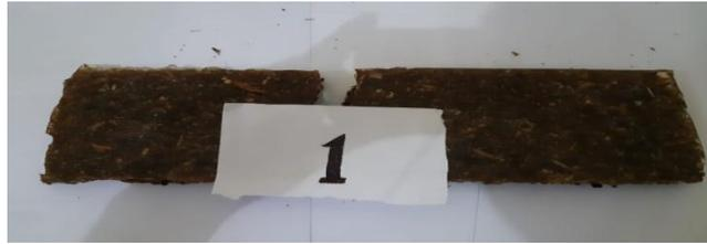
Gambar 4.33 spesimen 1 *matriks* ketiga hasil pengujian *Three Point Bending*
