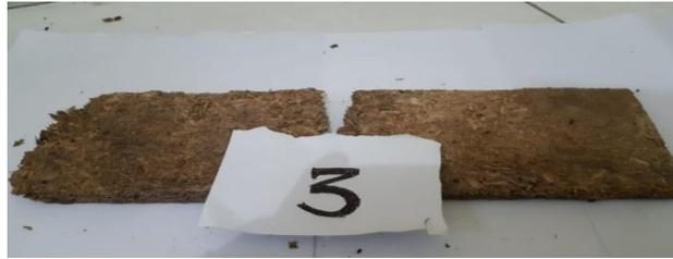
Gambar 4.24 spesimen 3 *matriks* kedua hasil pengujian *Three Point Bending*
