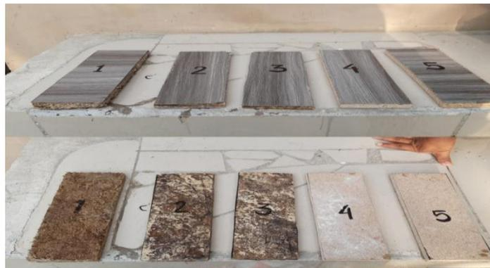
Gambar 3.32 Spesimen yang telah dilapisi dengan kertas HPL dan siap dilakukan pengujian *Three point bending*
