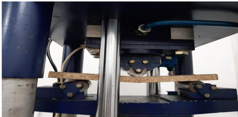
Gambar 4.79 Spesimen Pada saat dilakukan Pengujian *Three Point Bending*
