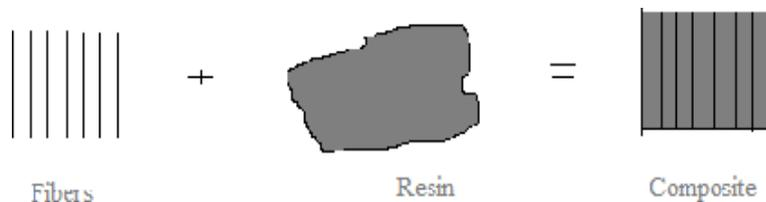
Gambar 2.1. Pembentukan material komposit menggunakan serat dan resin (Sanjay K. Mazumdar, 2001)
