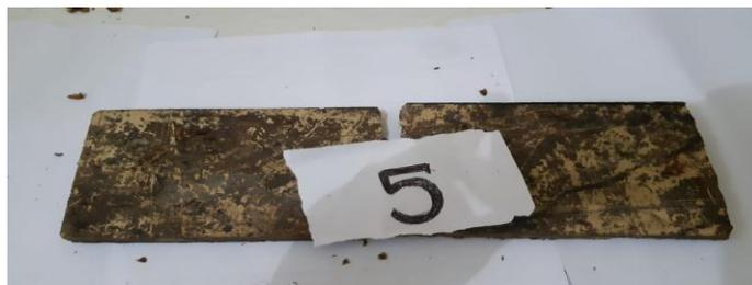
Gambar 4.60 spesimen 5 *matriks* keempat hasil Pengujian *Three Point Bending*
