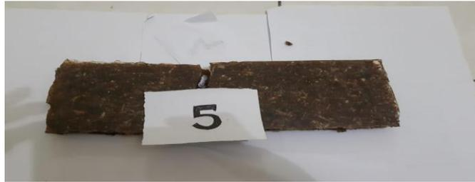
Gambar 4.45 spesimen 5 *matriks* ketiga hasil pengujian *Three Point Bending*
