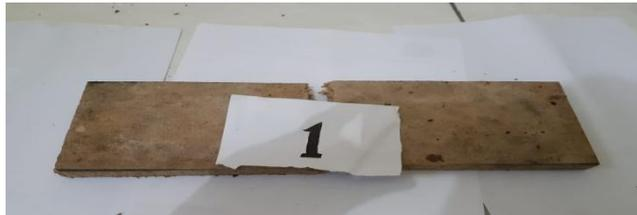
Gambar 4.63 spesimen 1 *matriks* kelima hasil pengujian *Three Point Bending*
