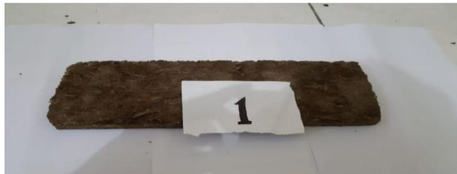
Gambar 4.17 spesimen uji 1 *matriks* kedua sebelum pengujian
