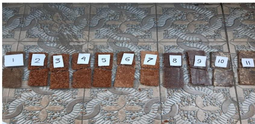
Gambar 4.80 Spesimen Hasil Pengujian *Three Point Bending*
