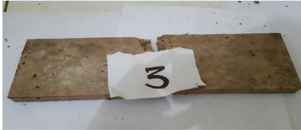
Gambar 4.69 spesimen 3 *matriks* kelima hasil pengujian *Three Point Bending*
