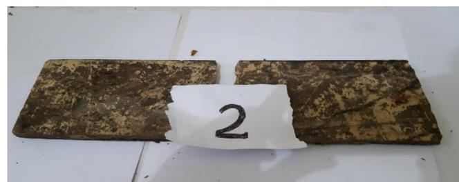
Gambar 4.51 spesimen 2 *matriks* keempat hasil pengujian *Three Point Bending*
