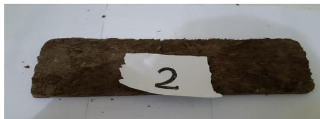
Gambar 4.20 spesimen uji 2 *matriks* kedua sebelum pengujian
