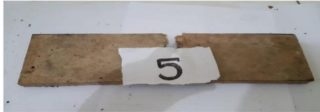
Gambara 4.75 spesimen 5 *matriks* kelima hasil pengujian *Three Point Bending*
