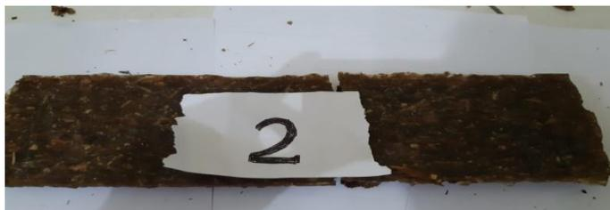
Gambar 4.36 spesimen 2 *matriks* ketiga hasil pengujian *Three Point Bending*
