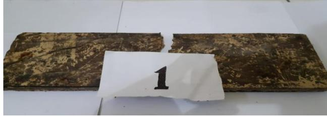
Gambar 4.48 spesimen 1 *matriks* keempat hasil pengujian *Three Point Bending*
