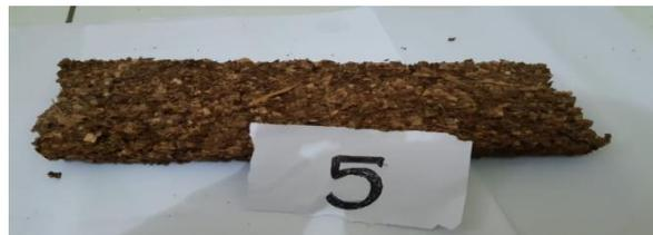
Gambar 4.14 spesimen uji 5 *matriks* pertama sebelum pengujian
