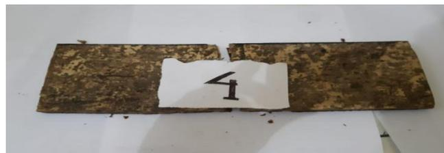
Gambar 4.57 spesimen 4 *matriks* keempat hasil pengujian *Three Point Bending*
