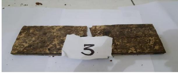
Gambar 4.54 spesimen 3 *matriks* keempat hasil pengujian *Three Point Bending*
