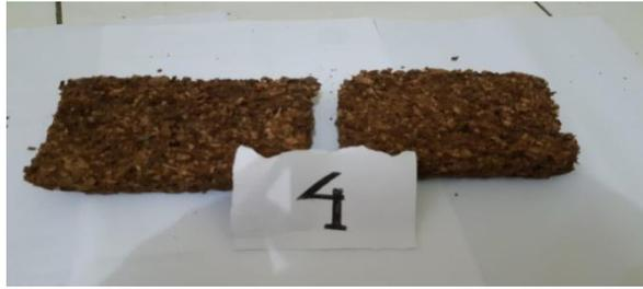
Gambar 4.12 spesimen 4 *matriks* pertama hasil pengujian *Three Point Bending*
