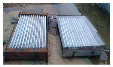
Gambar 4.1 Rancangan alat *solar water heater* dengan menggunakan kaca dan tanpa menggunakan kaca
