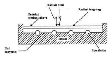
Gambar 2.5 Skema kolektor surya plat datar
