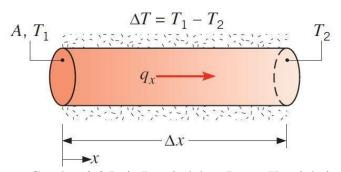
Gambar 2.8 Laju Perpindahan Panas Konduksi
