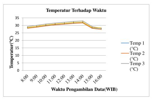
Gambar 4.16 Grafik pengaruh waktu terhadap temperatur pada saat gerimis Gambar 4.16 Merupakan grafik perubahan suhu/temperatur pada *solar water heater* tanpa menggunakan kaca saat gerimis.Suhu yang di hasilkan sedikit lebih tinggi di bandingkan dengan SWH yang menggunakan kaca .Namun,penurunan suhu yang terjadi lebih tinggi di bandingkan dengan yang menggunakan kaca.
