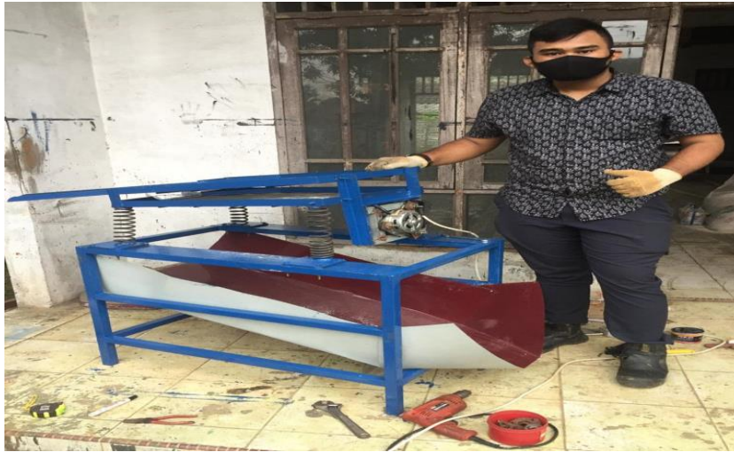
Gambar 4.10 Hasil pembuatan mesin ayakan tepung
