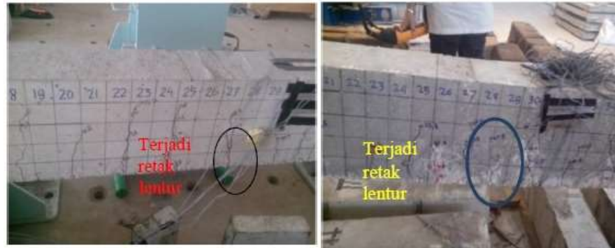
Gambar 2.2: Pola retak yang terjadi
