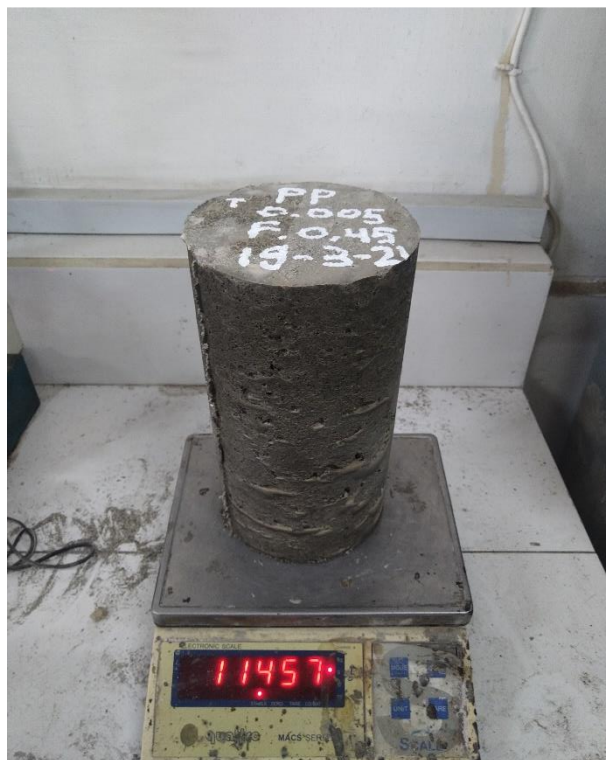
Gambar L.8: Menimbang Beton Sebelum dilakukan Perawatan.
