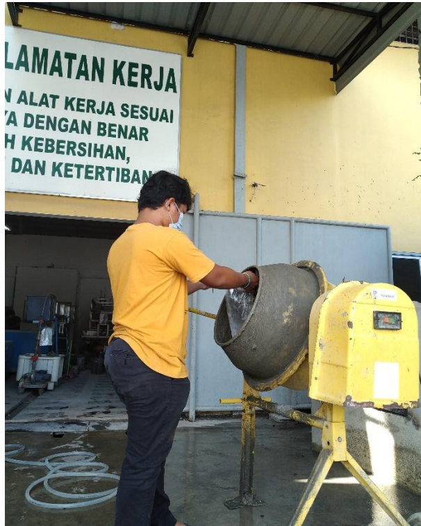
Gambar L.1: Mencampurkan Semua Bahan ke Dalam Mixer .
