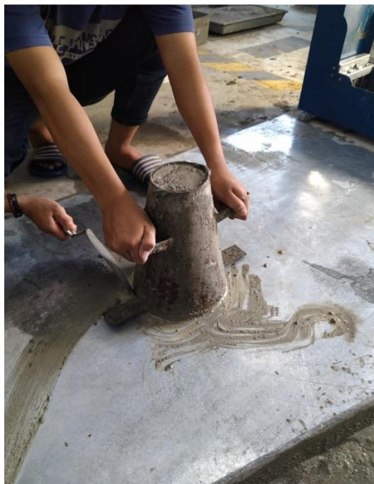
Gambar L.2: Melakukan Pengujian Slump flow .
