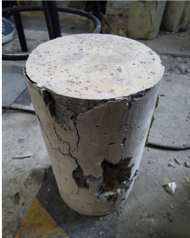
Gambar L.13. Beton Setelah Dilakukan Pengujian Kuat Tekan.
