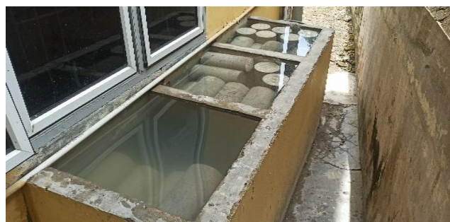
Gambar 3.6: Perawatan Beton Dengan Merendam Selama 28 Hari.
