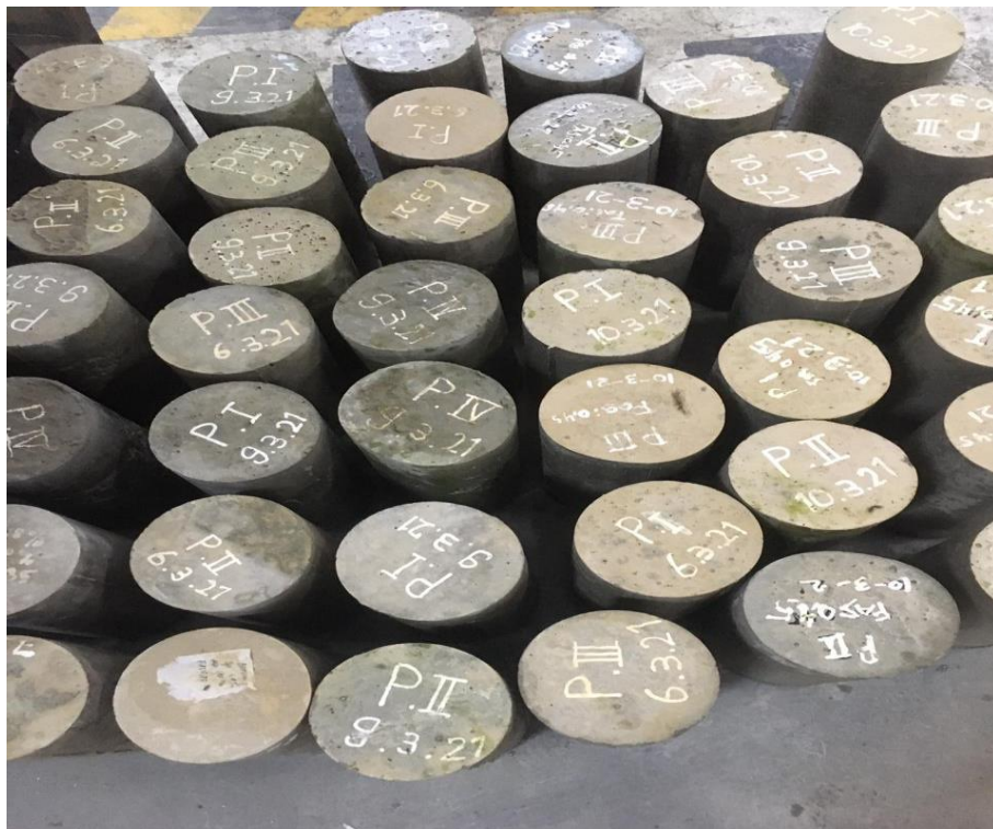
Gambar L.10: Mengeluarkan Beton Yang Sudah Direndam Selama 28 Hari.
