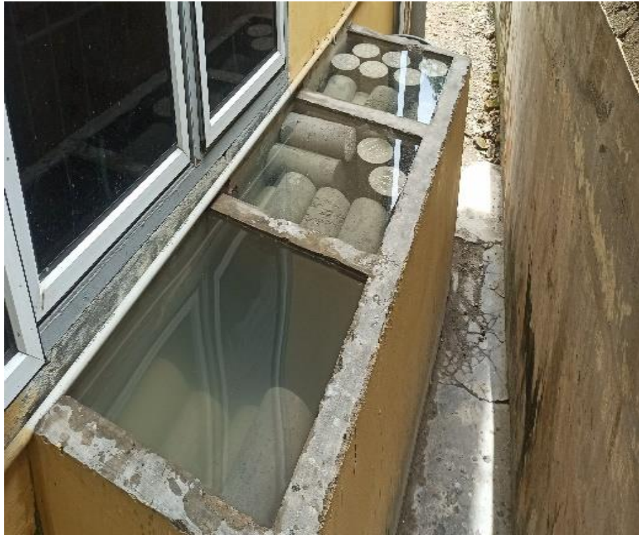
Gambar L.9: Melakukan Perawatan Beton Dengan Cara Merendam Beton Selama 28 Hari.
