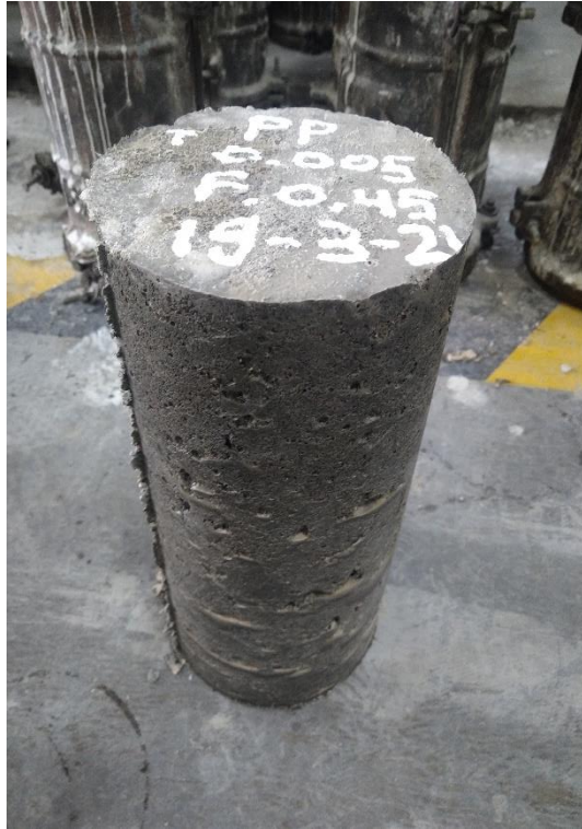
Gambar L.7: Beton Setelah Keluar dari Bekisting .
