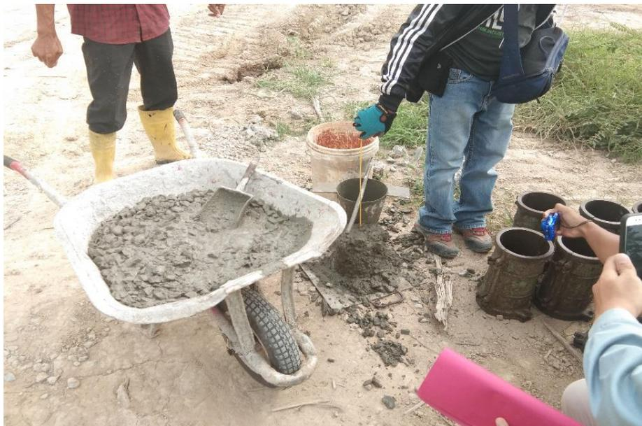
Gambar L4.8: Pengambilan sample beton dan uji slump saat penulis sebagai *quality control*
