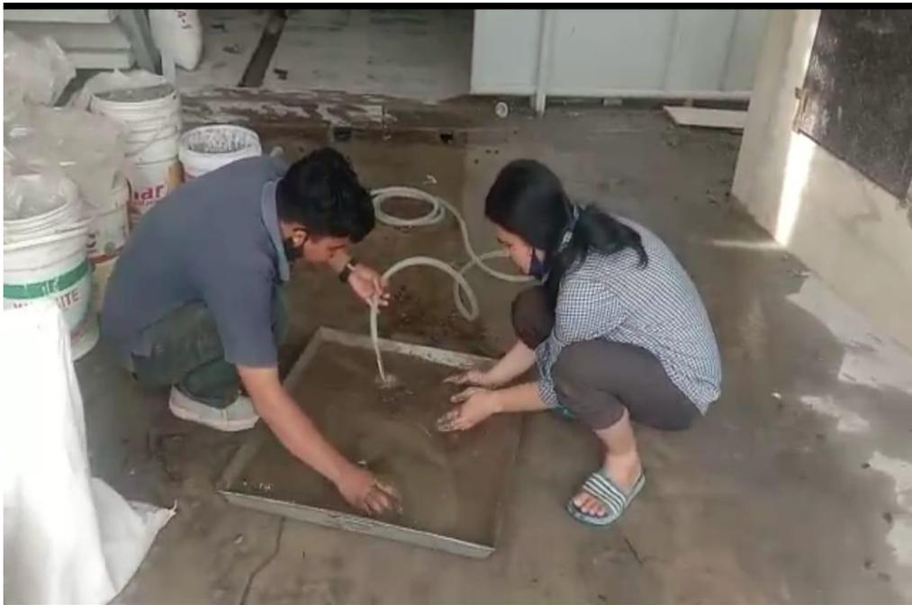
Gambar L2: Dokumentasi Pencucian agregat halus
