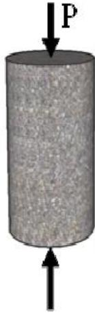
Gambar 2.3: Ilustrasi gaya pada pengujian kuat tekan
