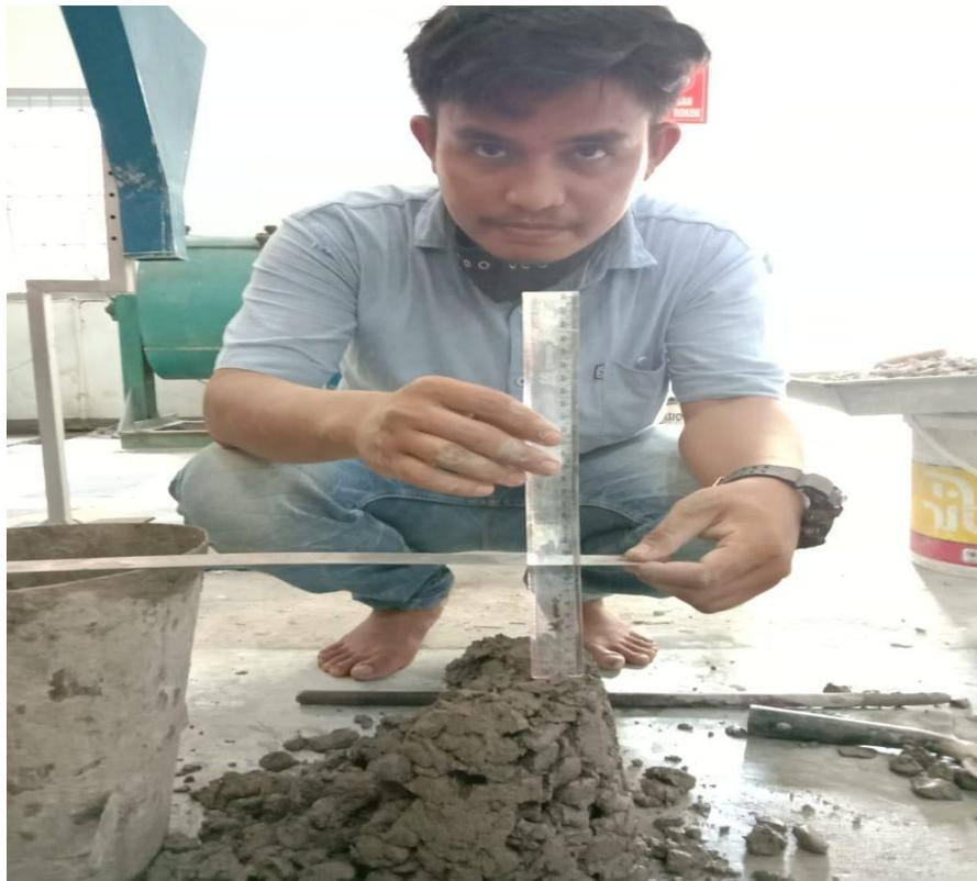
Gambar L18: Dokumentasi Slump test
