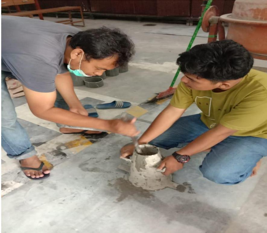
Gambar L17: Dokumentasi Slump test
