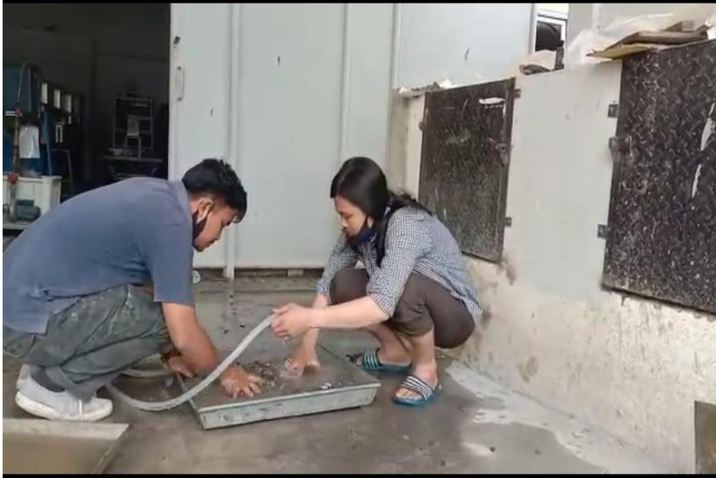
Gambar L1: Dokumentasi Pencucian agregat kasar
