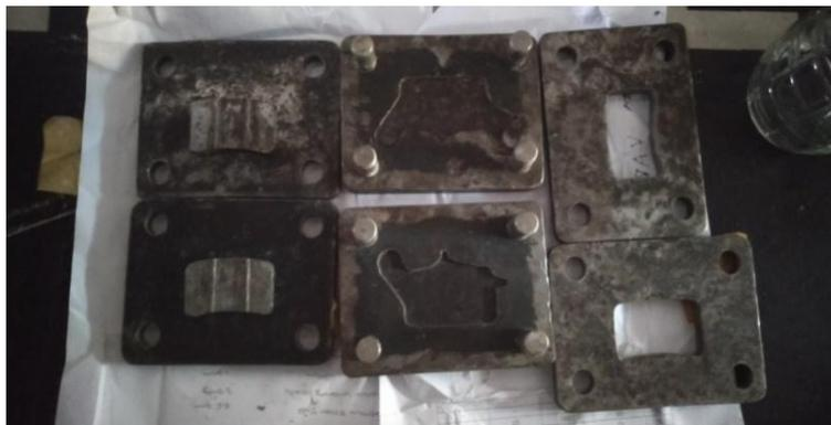
Gambar 3.2. Cetakan atau mal
