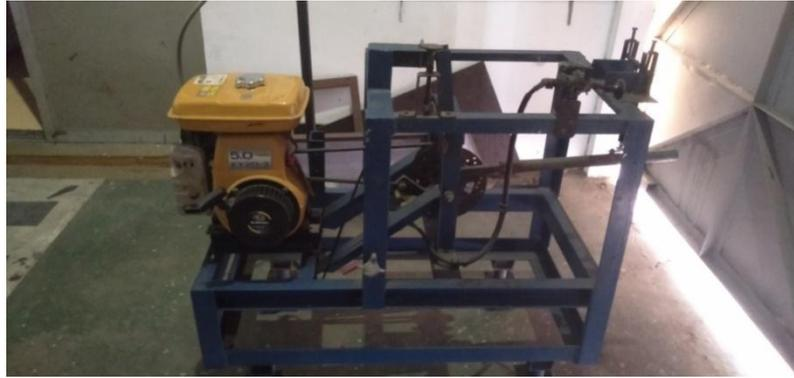
Gambar 3.5. Brake Dynamometer
