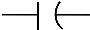
Gambar 2.7 Simbol Kapasitor Elektrolit
