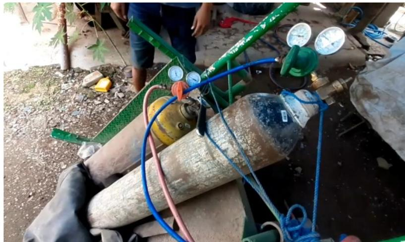
Gambar 3.3. Mesin las Asetilin
