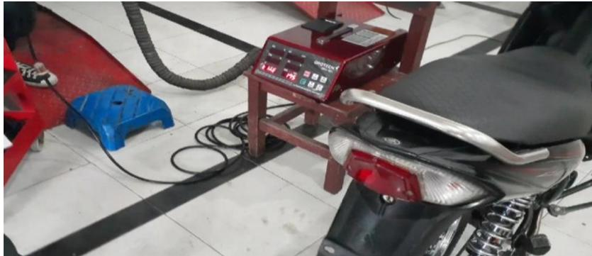
Gambar 4.13. Pengujian emisi gas buang dengan menggunakan Gas Analyzer
