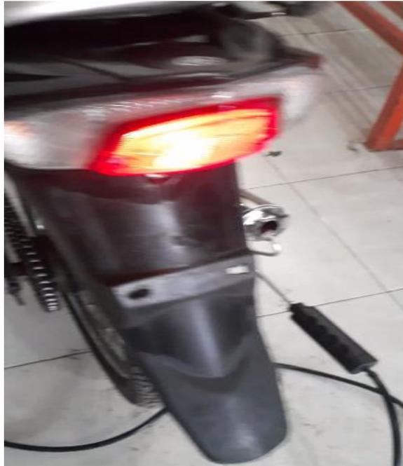
Gambar 4.20. pengujian pada kenalpot free flow
