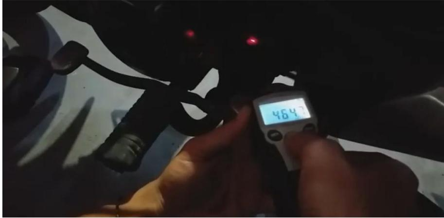
Gambar 4.18 pengukuran rpm dengan tachometer
