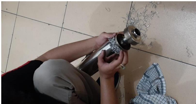
Gambar 4.16. Proses pemasangan gram *skrap aluminium*
