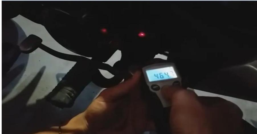
Gambar 4.11 pengukuran rpm dengan tachometer
