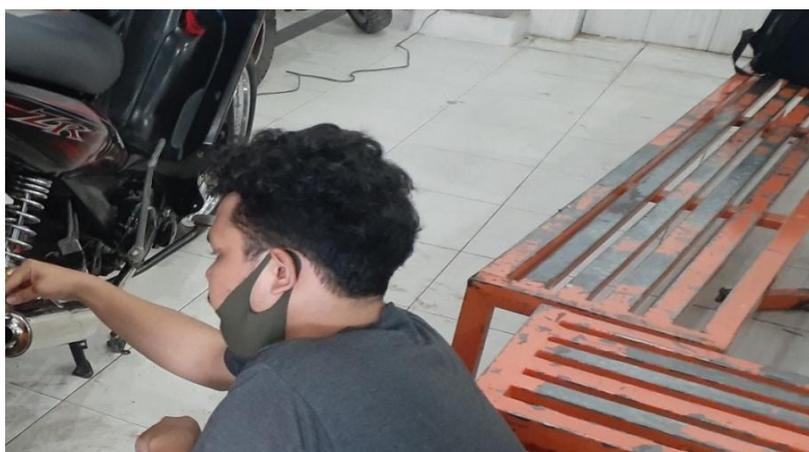
Gambar 4.17. proses pemasangan knalpot
