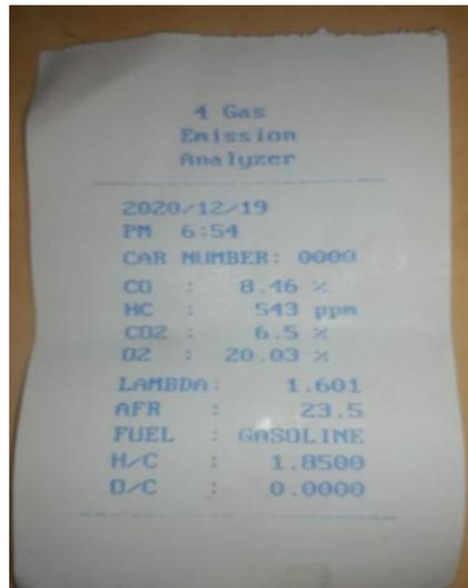
Gambar 4.23 prin-out data emisi gas buang dengan berat 70 gr
