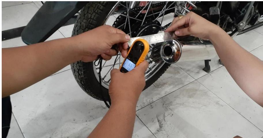
Gambar 4.19 Pengukuran kecepatan angin gas buang
