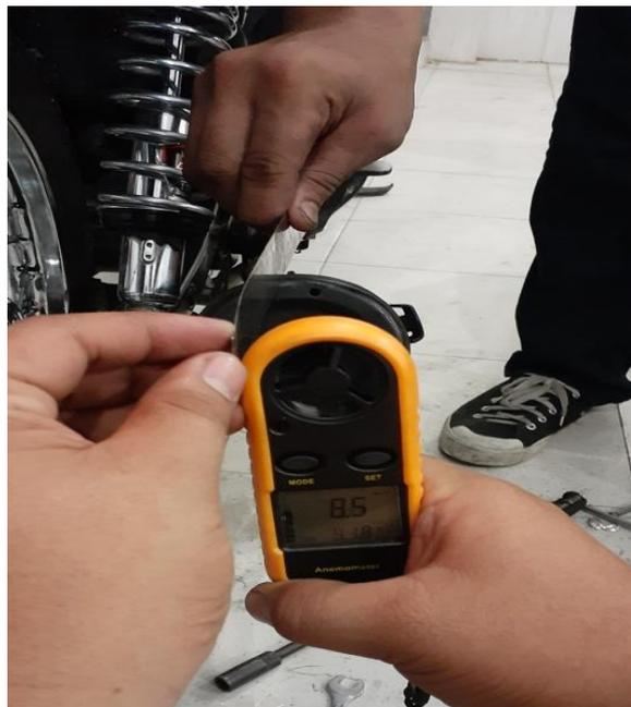
Gambar 4.12. Pengukuran kecepatan angin gas buang
