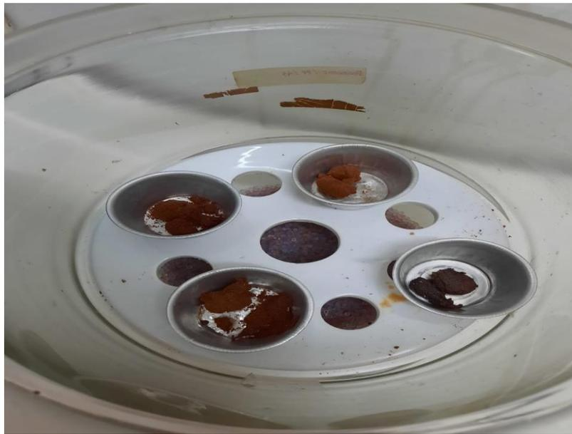
Gambar 19. Pendinginan di Desikator untuk Uji Kadar Air
