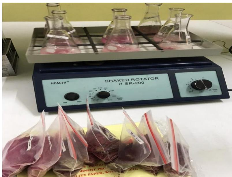
Gambar 22. Alat Shaker Rotator untuk Menghomogenkan Bahan untuk Uji Antioksidan
