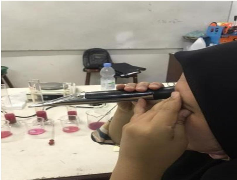
Gambar 21. Uji Padatan Terlarut dengan Alat Refraktometer
