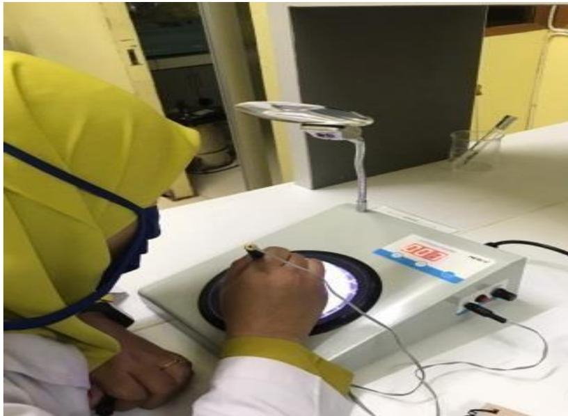
Gambar 26. Perhitungan Total Mikroba dengan *Collony Counter*
