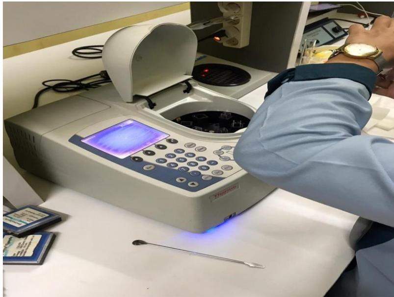
Gambar 23. Uji Antioksidan dengan Alat Spektrofotometer
