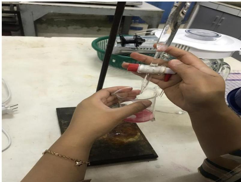
Gambar 20. Titrasi untuk uji Total Asam
