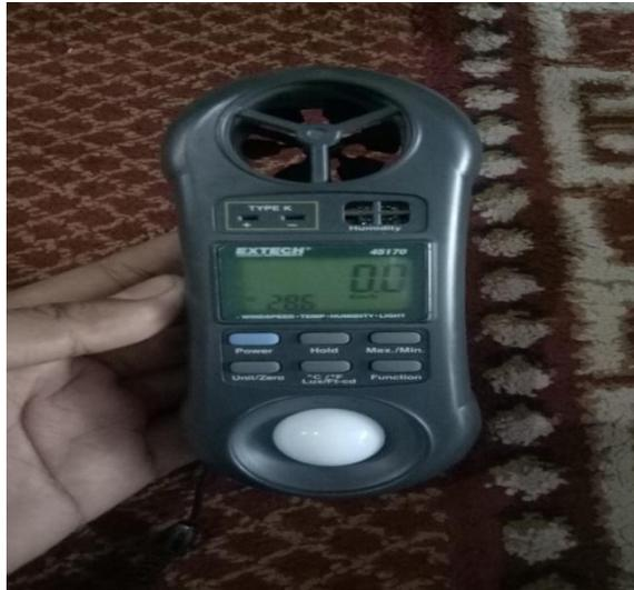
Gambar 3.28 *Anemometer*
