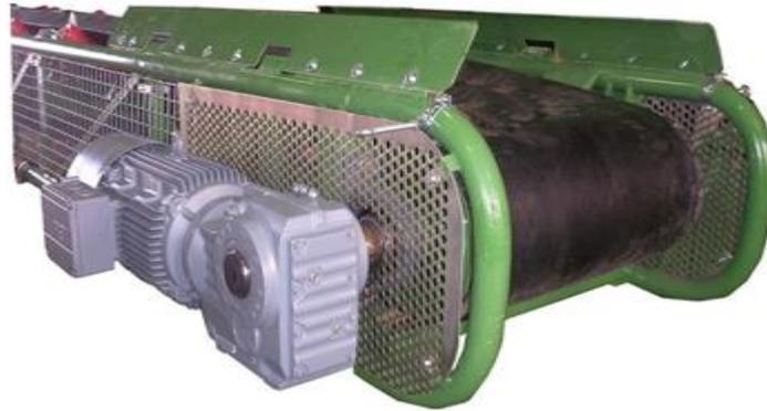
Gambar 2.31 *Unit Penggerak (drive units)*
