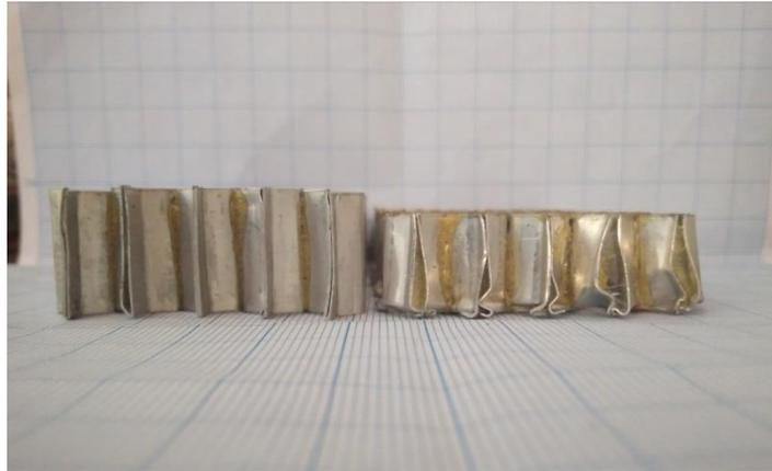
Gambar 4.16 : Pola perubahan bentuk spesimen
