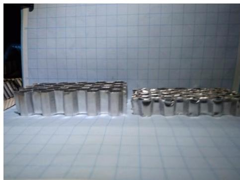
Gambar 4.18 : Pola perubahan bentuk spesimen
