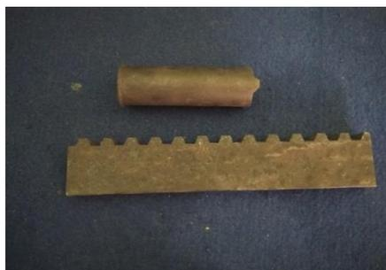
Gambar 3.8: Cetakan spesimen ukuran hexagonal 4 mm
