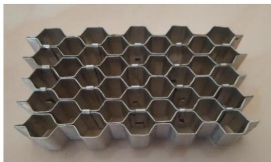
Gambar 4.7: Spesimen ukuran hexagonal 4 mm
