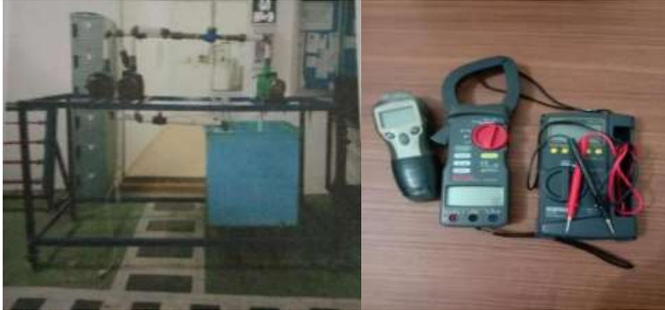
Gambar 4.1 Alat Uji Pompa Sebagai Turbin
