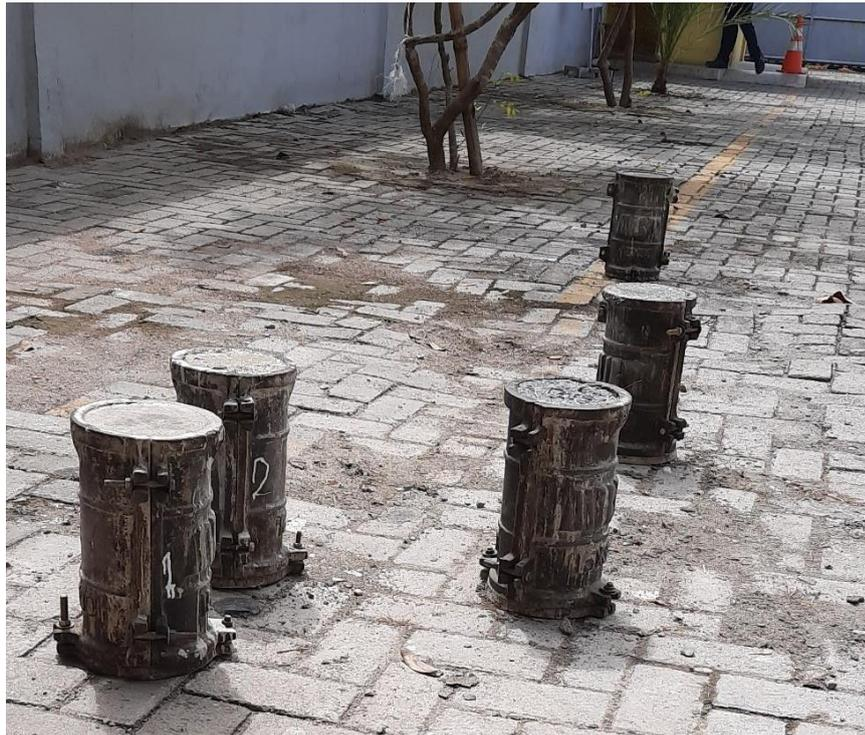
Gambar L7: Dokumentasi proses perawatan beton
