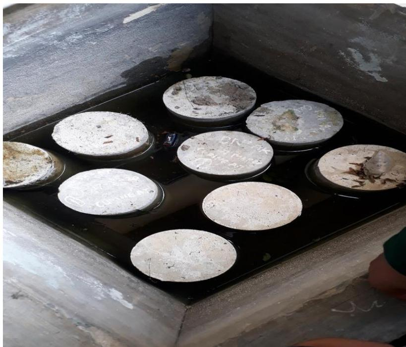
Gambar L8: Dokumentasi proses perawatan beton
