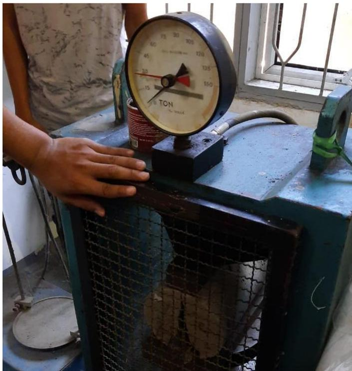
Gambar L9: Dokumentasi pengujian kuat tarik belah beton
