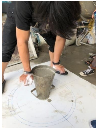
Gambar 3.5 Pemeriksaan Slump Flow
