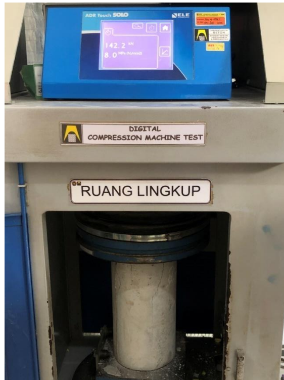
Gambar L17. Pengujian Kuat Tekan
