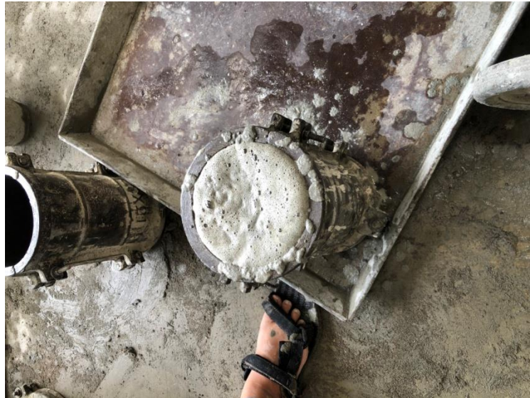
Gambar L13. Mengisi Beton Ke dalam Bekisting
