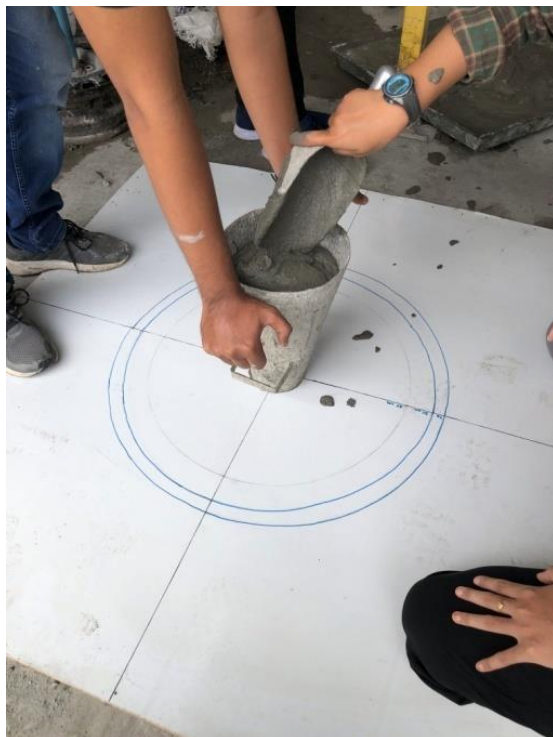
Gambar L10. Melakukan Pemeriksaan Slump Flow
