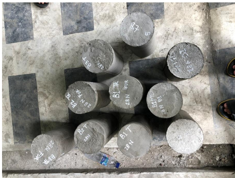
Gambar L16. Beton yang telah dikeluarkan dari bak perendam
