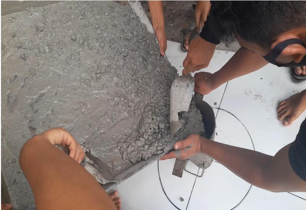
Gambar L.19: Proses pengujian *slump flow*.
