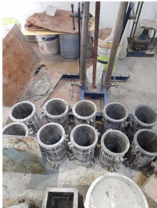
Gambar L.4: Cetakan Silinder.
