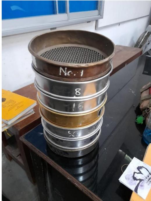
Gambar L.3: Saringan Agregat Halus.
