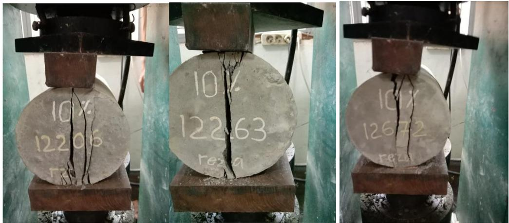
Gambar L.26: Pengujian kuat tarik belah BAC-10.
