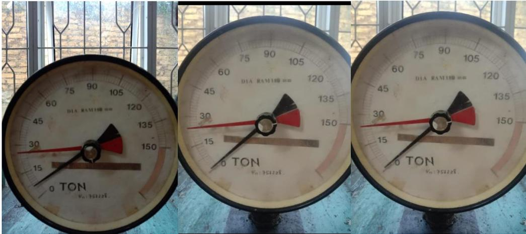
Gambar L.33: Hasil pengujian kuat tarik belah BAC-30%.
