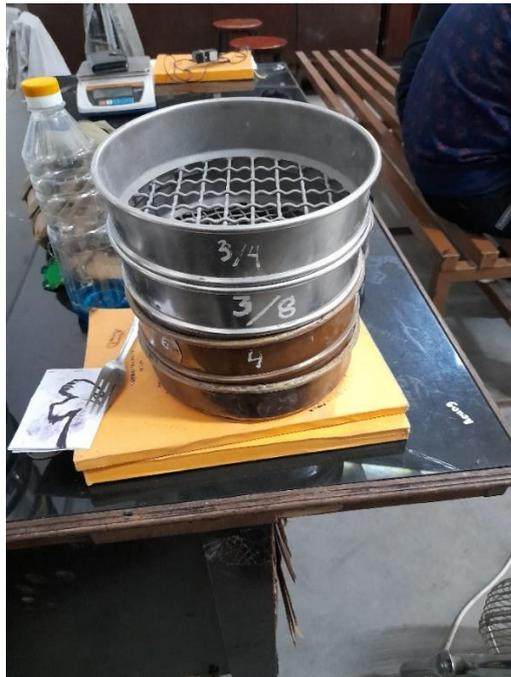
Gambar L.2: *Saringan Agregat Kasar.*
