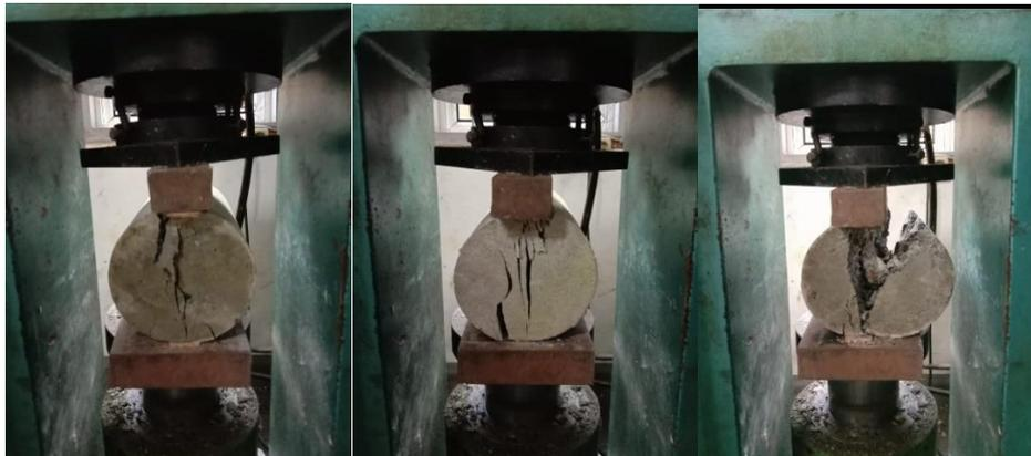
Gambar L.32: Pengujian kuat tarik belah BAC-30%.
