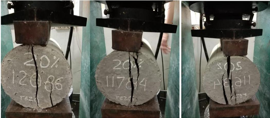
Gambar L.29: Pengujian kuat tarik belah BAC-20%.
