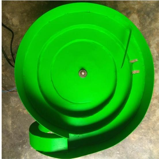
Gambar 4.5 Pengujian Trek spiral pada Mangkuk (*Bowl*)
