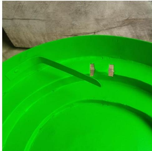
Gambar 4.6 Pengujian Trek penyortir tutup botol pada mangkuk
