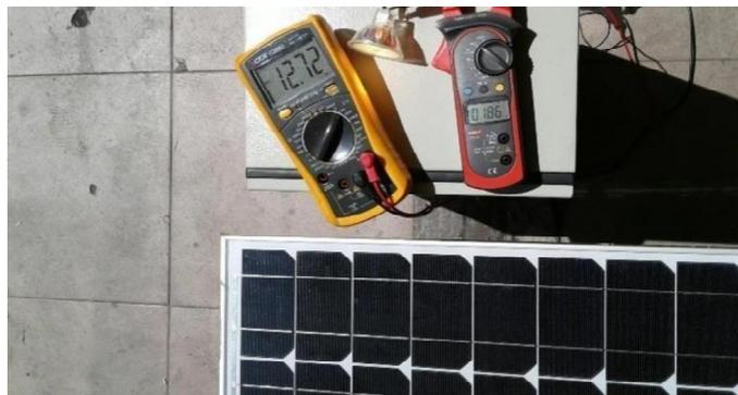
Gambar 4-3. Pengukuran arus dan tegangan keluaran panel tiap jam.
