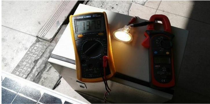
Gambar4-2 Pengujian panel dengan menggunakan lampu halogen 50 W.
