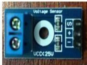
Gambar 2.10 Modul Sensor Tegangan
