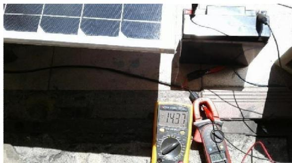
Gambar 4-7 Pengukuran tegangan dan arus saat tegangan baterai mencapai 14,37V.
